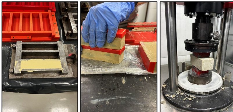
Abbildung 3: Beispielhafte Arbeitsschritte (Herstellung und Ausschalen der Probekörper, Druckfestigkeitsbestimmung)
