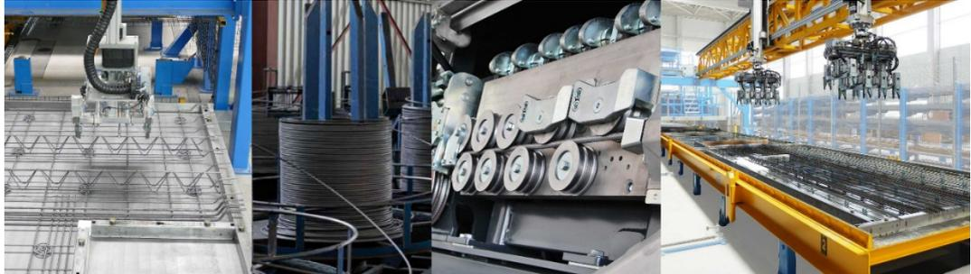
*Bild 1: Innovative Bewehrungstechnik und automatisierte Verlegeprozesse mit Betonstahl aus Ringen (Bildquelle: [www.progress-m.com](http://www.progress-m.com))*
