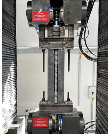
Abb. 4: Zugversuch der mit Glasfaser versehenen Einzellitzenstänglied an der HTWK Leipzig
