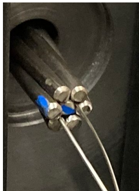
Abb. 1: In Spannstahlлите integrierte Glasfaser zur Dehnungsmessung
