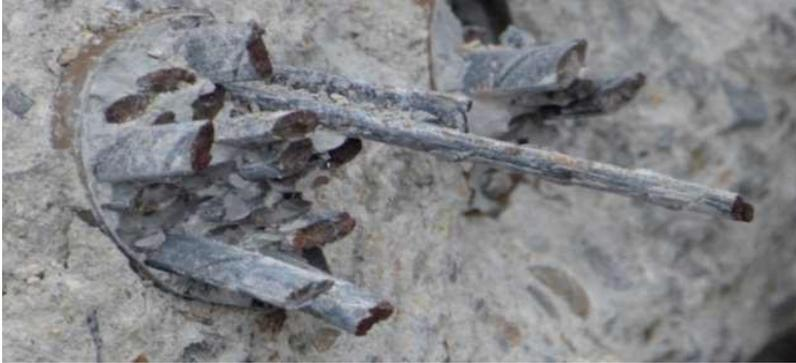
**Abb. 5:** Aufnahmen von Drahtbruchflächen in Achse D (Fotos: MKP GmbH)
