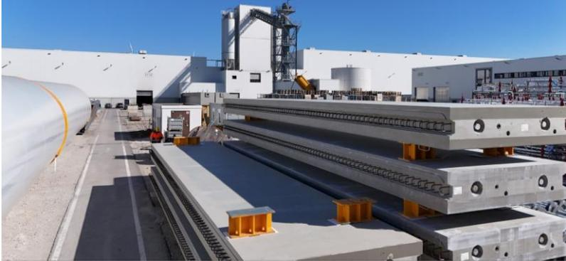
**Abb. 2:** Modulplatten im Werk Sengenthal. Quelle: Firmengruppe Max Bögl
