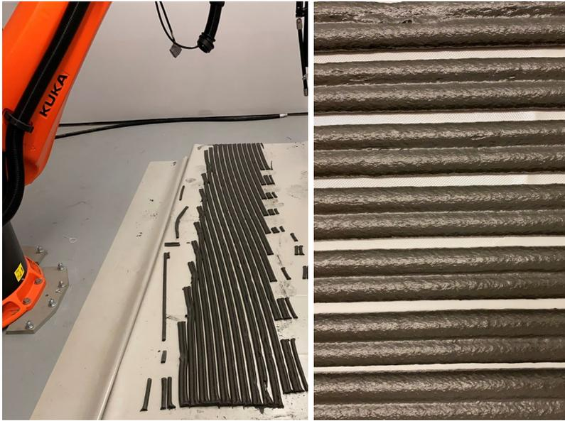
**Abb. 5:** Baupraktische Realisierung der in Abb. 3 geplanten Druckpfade (links) und Detailaufnahme der Extrusionsstränge (rechts)
