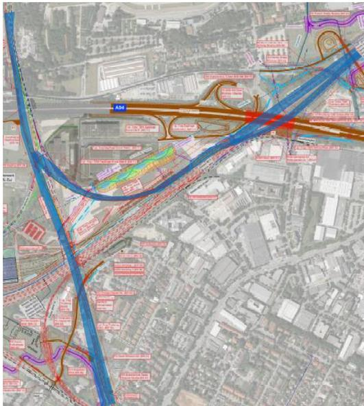
**Abb. 3:** Übersicht der Trog- und Tunnelbereiche im Rahmen der DTK
