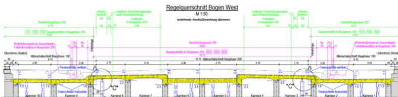
**Abb. 12:** Bauabschnitte für Rück- und Neubau der Fahrbahnplatte der Äußeren Ludwigsbrücke
