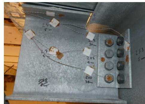
Abbildung 1: Grobbrandversuch an feuerverzinkte Verbundträger mit Anschlüssen in der Mitte
