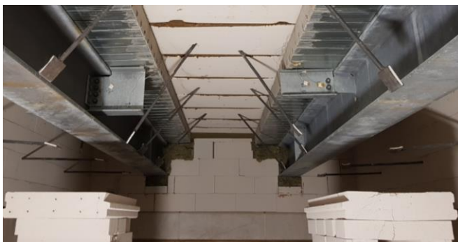
Abbildung 1: Grobbrandversuch an feuerverzinkte Verbundträger mit Anschlüssen in der Mitte
