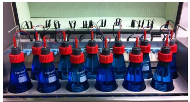
Abb. 3: Sapromat zur Messung des biologischen Sauerstoffbedarfs (BSB)
