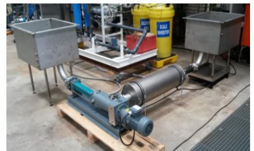
Abb. 6: Untersuchung des Einflusses der Ultraschallvorbehandlung auf die anaerobe Abbaubarkeit von Klärschlamm im Technikumsmaßstab
