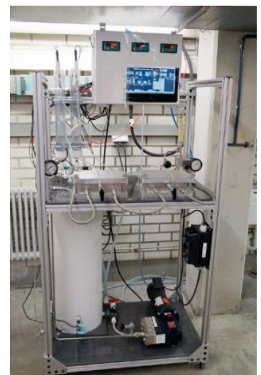
Abb. 32: Teststand zur Charakterisierung von Flachmembranen
