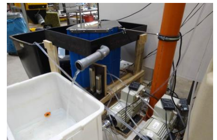
Abb. 18: Versuchsstand zur Untersuchung eines Schachtsystems
