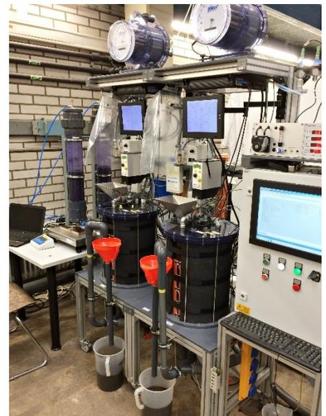
Abb. 12: Kontinuierlich betriebene Biogastestreaktoren.
