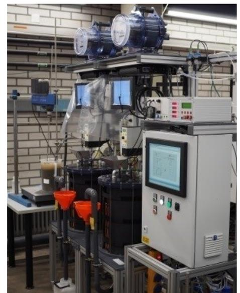
Abb. 7: Kontinuierlich betriebene Biogastestreaktoren.
