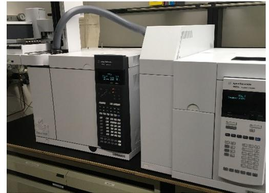
Abb. 3: Gaschromatograph (GC-FID) gekoppelt an den Headspace-Probengeber.
