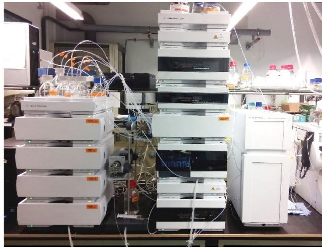
Abb. 36: SFC Anlage mit massenspektrometrischer Detektion in unserem Labor.
