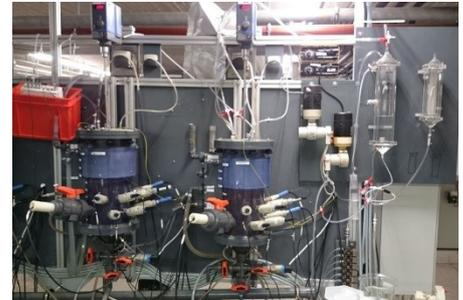
Abb. 8: Automatisierte Bioreaktoren nach dem Vorbild der EAWAG.
