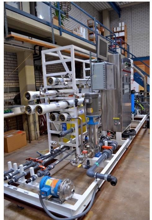
Abb.1: Nanofiltrationspilotanlage (80 L/min).
