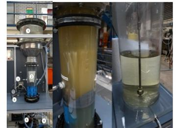
Abb. 32: Ultrafiltrationsteststand zur Behandlung kommunalen Rohabwassers.
