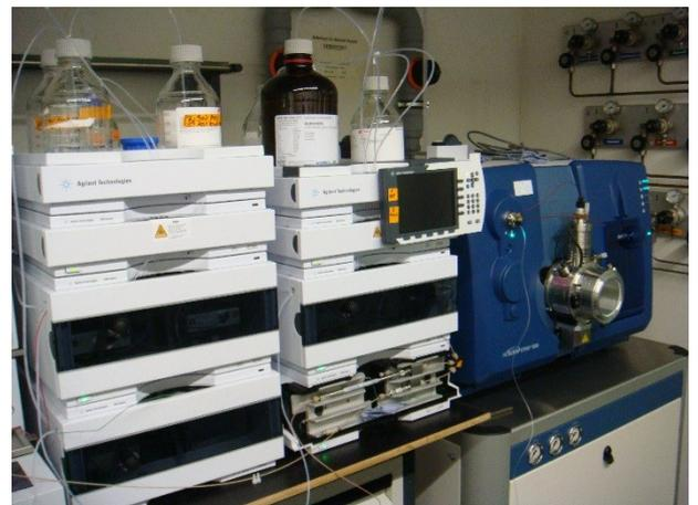
Abb. 4: RP-HILIC Kopplung mit MS/MS Detektion für die organische Spurenstoffanalytik.
