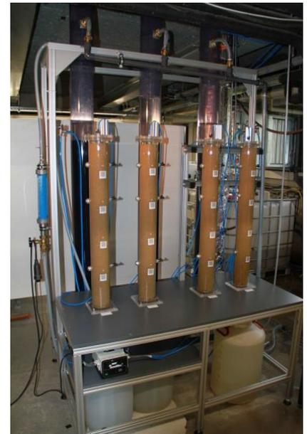
Abb. 29: Aufbau der Biofilter.
