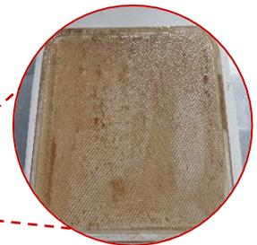
Abb. 34. Überwachung des UO-Permeatflusses über die Zeit während der kommunalen Abwasserbehandlung und der Membranoberfläche nach Auftreten von Biofouling.
