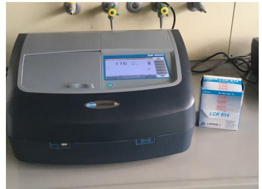
Abb. 2: Bestimmung von Einzel- und Summenparametern über Küvetten-Schnelltests mit Hilfe des Photometers von HACH.
