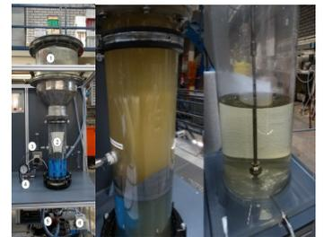
Abb. 25: Ultrafiltrationsteststand zur Behandlung kommunalen Rohabwassers
