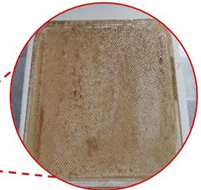
Abb. 27: Überwachung des UO-Permeatflusses über die Zeit während der kommunalen Abwasserbehandlung und der Membranoberfläche nach Auftreten von Biofouling
