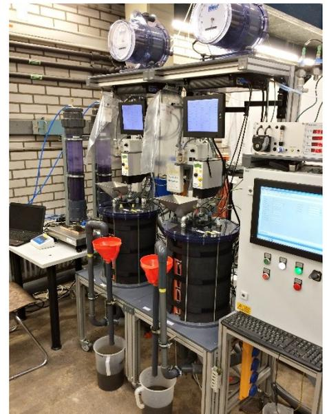
*Abb. 11: Kontinuierlich betriebene Biogasreaktoren*
