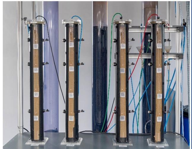
Abb. 17: Aufbau der Filter für die sequentielle Biofiltration
