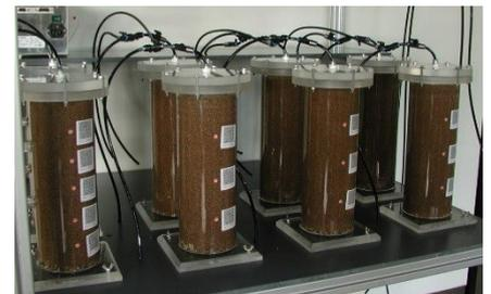
Abb. 16: Säulenversuche im Labormaßstab an der TUM
