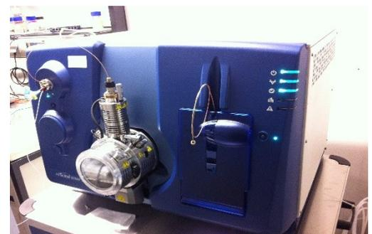
Abb. 3: QTRAP-MS-System von ABSciex für die hochsensitive Detektion von Spurenstoffen
