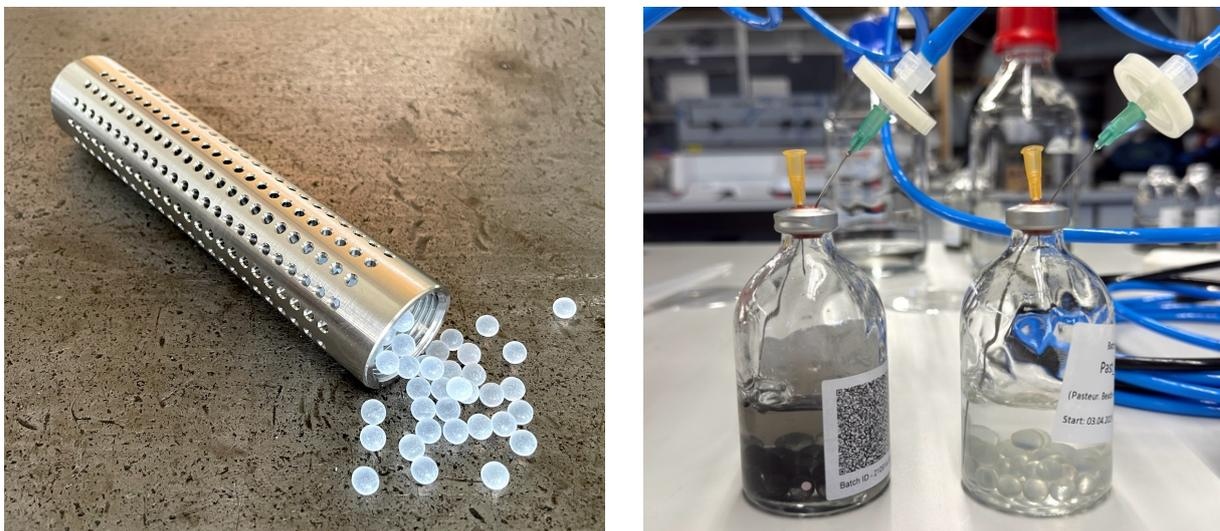
**Abb. 60** Links: Erste Version der Aufwuchskörper bestehend aus einer 150 mm langen und 32 mm im Durchmesser großen perforierten Edelhstahlhülse, gefüllt mit angerauten Glaskugeln als Aufwuchsmedium für autochtone Mikroorganismen im Aquifer der Demonstrationsanlage Berlin-Johannisthal. Rechts: Batch-Test zum Spurenstoffabbau mit der autochtone Biozönose mithilfe zuvor inkubierter und mit Biofilm bewachsener Glaskugeln unter unterschiedlichen, kontrollierten Milieubedingungen.
