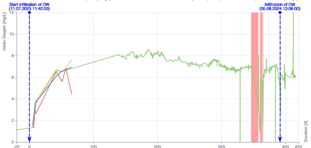
**Abb. 35** Entwicklung der gelösten Sauerstoffkonzentrationen als Stundenmittelwerte in der GWM 4 und in unterschiedlichen Tiefen (9,7/11 m uGOK zusammengefasst zu 10 m uGOK), innerhalb der ersten 416 Tage nach Inbetriebnahme der SMART 2.0 Demonstrationsanlage in Berlin-Johannisthal. Rotmarkierte Bereiche kennzeichnen Zeiträume mit längeren Ausfällen der Infiltration. Bekannte Artefakte, z. B. bedingt durch Störung der Messstelle, wurden entfernt.
