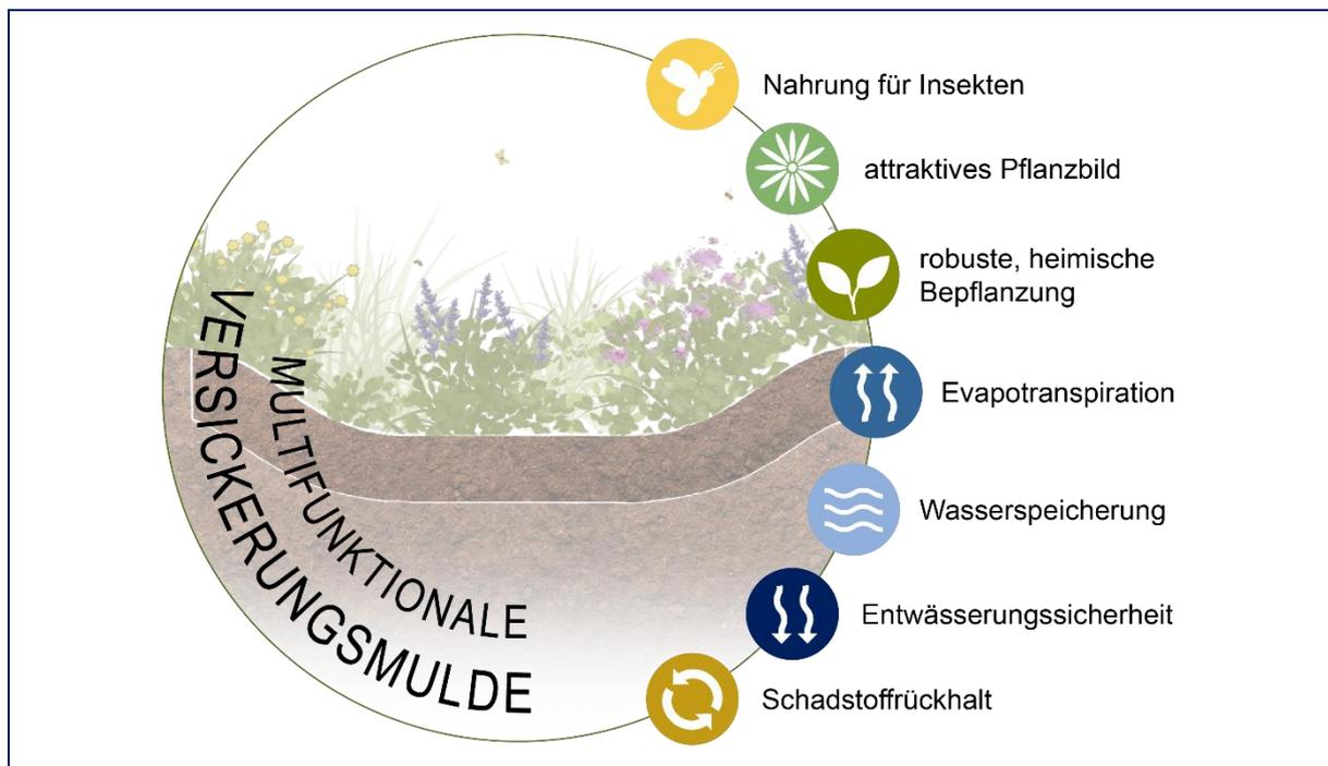
Abbildung 1: Funktionen einer „multifunktionalen Versickerungsmulde“
