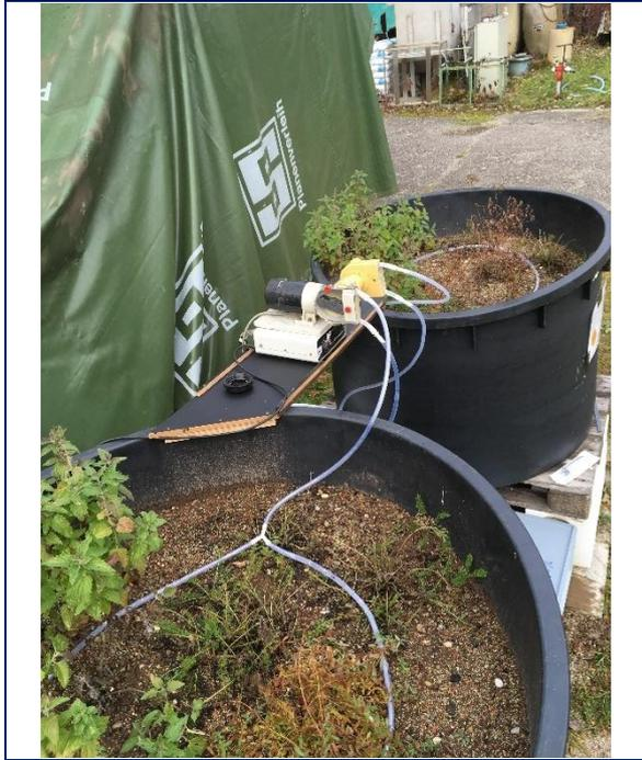
Abbildung 12: Versuchsaufbau der halbtechnischen Versuche mit Peristaltikpumpe und perforierten Schlauchring an der TUM
