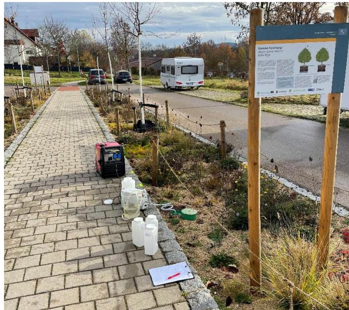
Abbildung 22: Aufbau der ersten Probenahme des Sickerwassers am 25.11.22
