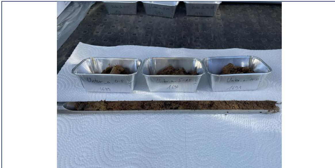
Abbildung 14: Tiefenorientierende Untersuchung der bewachsenen Bodenzone an der Pilotierung/Otto-Warburg-Straße
