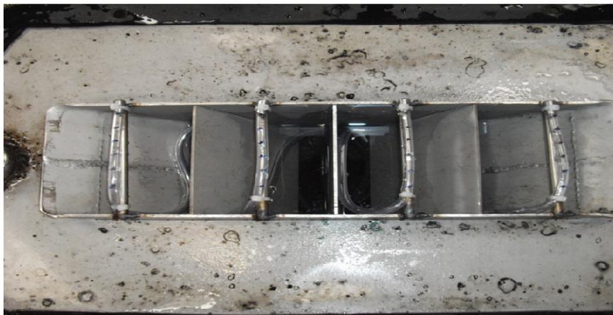
**Abbildung 73 Diffuser zur Verteilung der Biogas- und Schlammströme**
