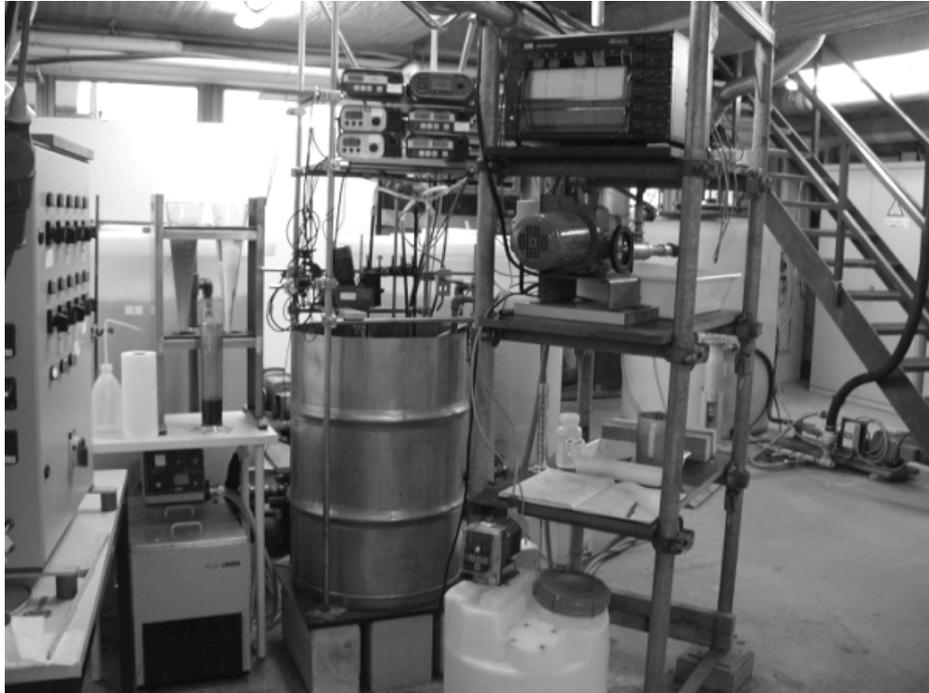
**Abbildung 61: SBR zur Deammonifikation mit „Swinging Redox“**
