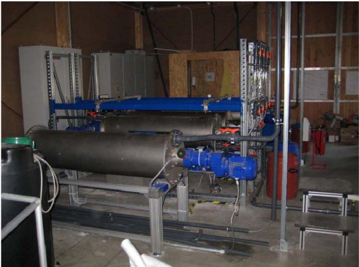
**Abbildung 50: Keramische Rotationsscheibenfilter (Bellmer Fine Filter)**
