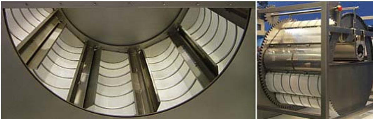
**Abbildung 15: Mikrosiebung von Passavant-Geiger ([http://www.passavant-geiger.de/page/page\\_ID/103?PHPSESSID=87ef5a4b1b25d5d739d69137bf1d584e#](http://www.passavant-geiger.de/page/page_ID/103?PHPSESSID=87ef5a4b1b25d5d739d69137bf1d584e#); Stand: 15.10.2008)**
