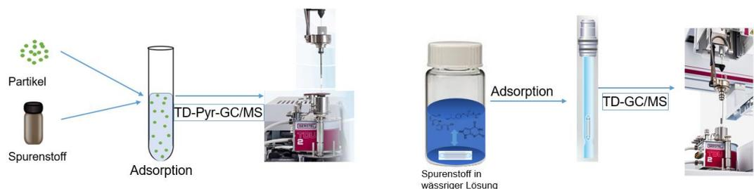
Abbildung 37: Analytik der Partikel mit TD-Pyr-GC/MS (links) und mit Gerstel Twister® (rechts)
