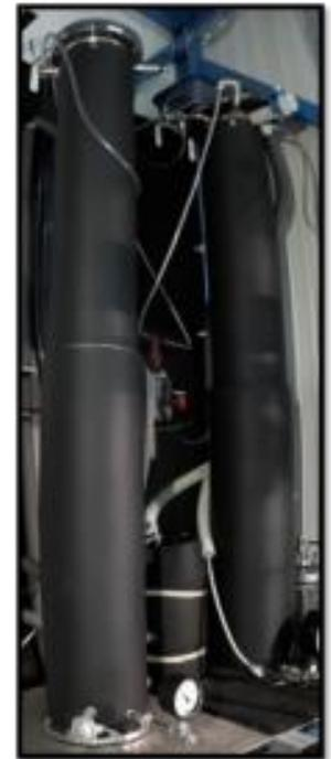
Abbildung 15: Rieselbettreaktor im halbtechnischen Maßstab
