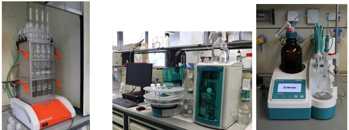
Abbildung 5: Links: CSB/SMA 12 L der Firma Behr; Mitte: Ionenchromatographie-System 930 IC Compact Flex mit 858 Professional Sample Prozessor der Firma Metrohm; Rechts: Eco Titrator A-cid/Base der Firma Metrohm
