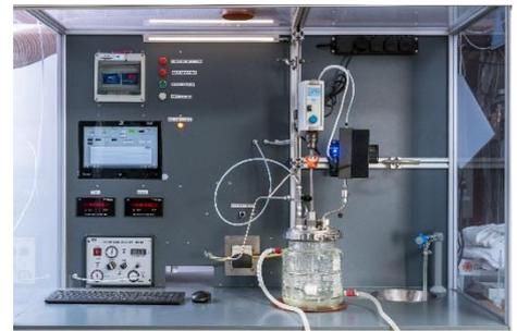
Abbildung 20: Laborozonanlage
