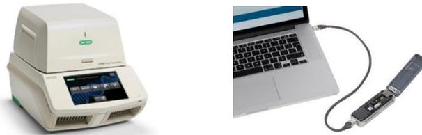
*Abbildung 30: qPCR Analyse zur Quantifizierung von Antibiotikaresistenzgenen, und ein USB-Sequenzierer der dritten Generation zur Analyse von Markergenen, Genomen und Metagenomen*
