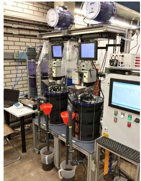
*Abbildung 17: Kontinuierlich betriebene Biogastestreaktoren*
