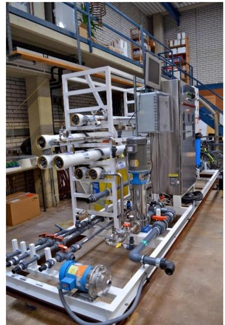
Abbildung 1: Nanofiltrationspilotanlage
