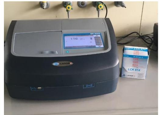
Abbildung 2: Bestimmung von Einzel- und Summenparametern über Küvetten-Schnelltests mit Hilfe des Photometers von HACH
