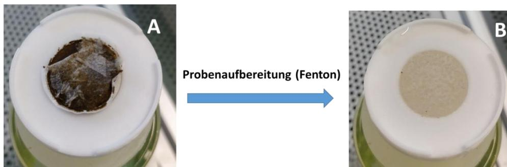
Abbildung 35: Probenaufbereitung zur Entfernung organischer Materie: A: Schlammprobe, B: Nach Fenton Behandlung.
