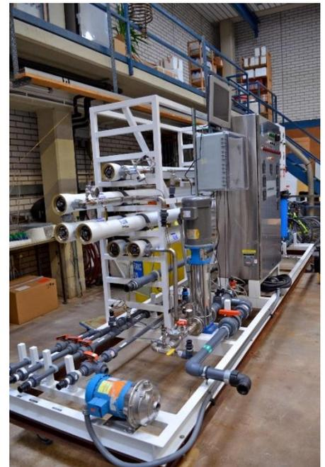
Abbildung 1: Nanofiltrationspilotanlage (80 L/min).
