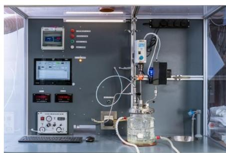
Abbildung 16: Laborozonanlage zur Untersuchung der Spurenstoffentfernung und Desinfektion.
