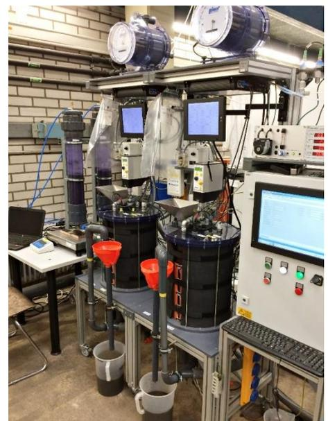
Abbildung 13: Kontinuierlich betriebene Biogastestreaktoren.
