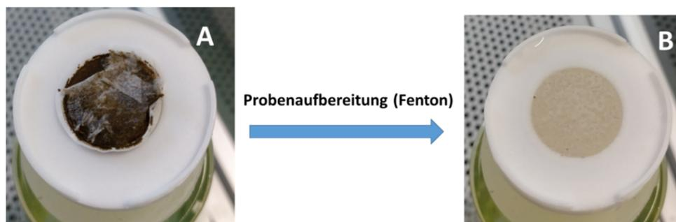
Abbildung 43: Probenaufbereitung zur Entfernung organischer Materie: A: Schlammprobe, B: Nach Fenton Behandlung.
