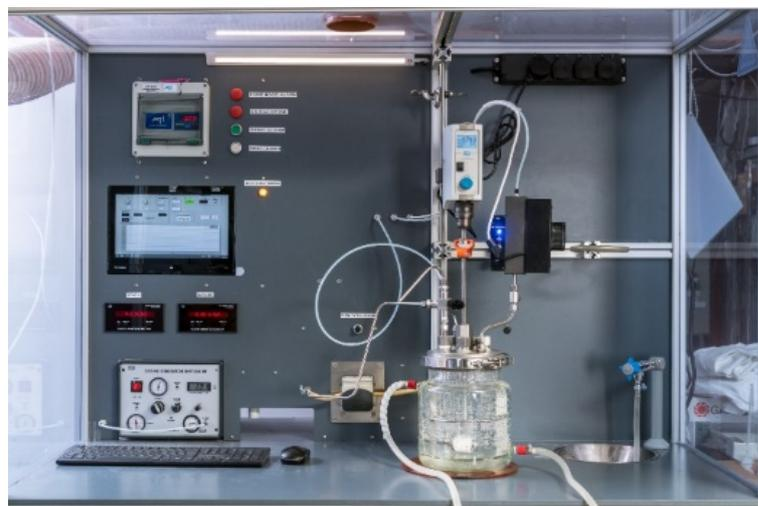
Abbildung 19: Laborozonanlage zur Untersuchung der Spurenstoffentfernung und Desinfektion.
