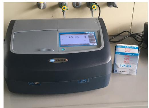
Abbildung 2: Bestimmung von Einzel- und Summenparametern über Küvetten-Schnelltests mit Hilfe des Photometers von HACH.
