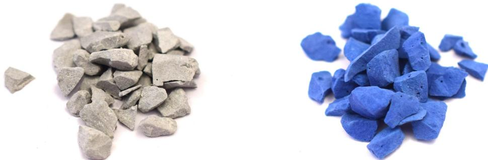
Abbildung 27: Zementsteingranulate vor (links) und nach (rechts) der Farbbeaufschlagung mit Remazol Brilliant Blau.
