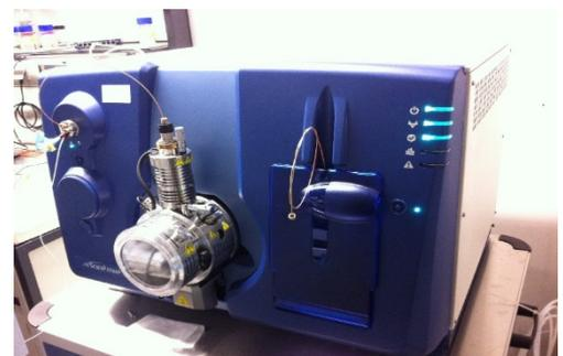
Abbildung 3: QTRAP-MS-System von ABSciex für die hochsensitive Detektion von Spurenstoffen.
