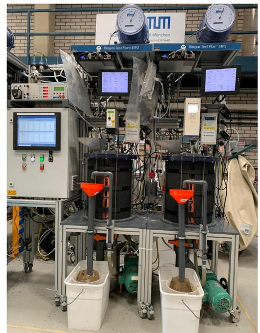
Abbildung 13: Kontinuierlich betriebene Reaktoren im Technikumsmaßstab.
