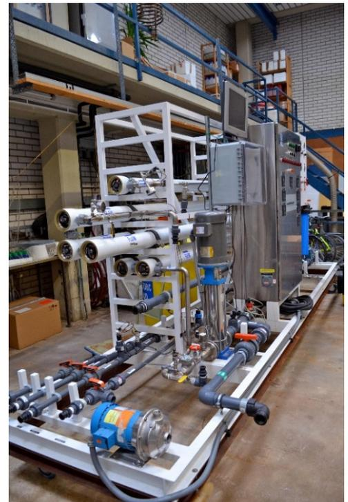
Abbildung 1: Nanofiltrationspilotanlage (80 L/min).
