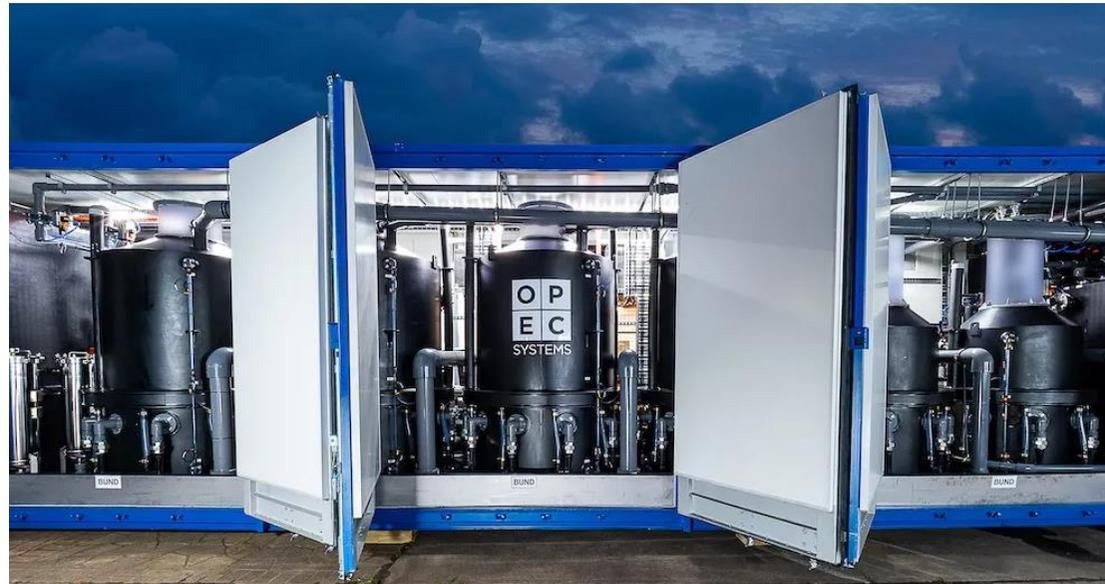
**Abbildung 7:** Mobiles SAFF® (Surface Active Foam Fractionation) System von OPEC Systems, ausgeführt als Containerlösung (Bildquelle: [27]).
