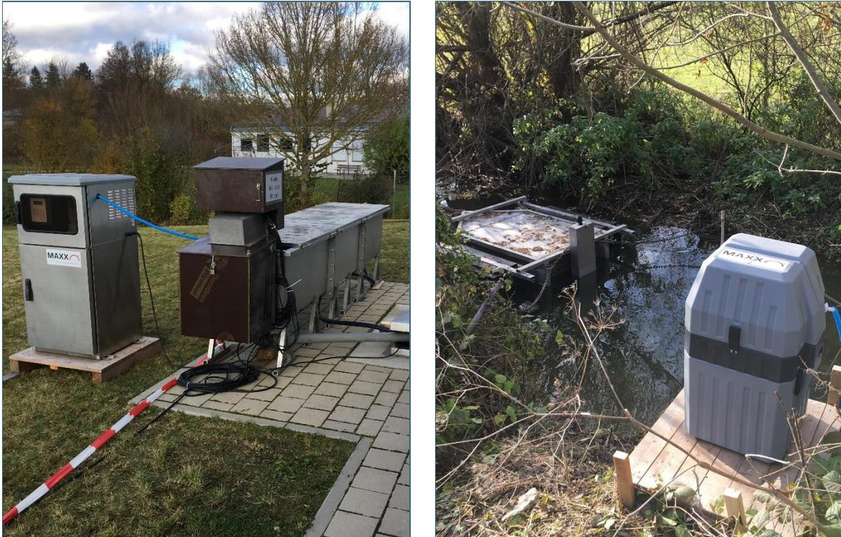
Abb. 63: Langstromrinne (links) am Standort Kläranlage Weißenburg vor der weitergehenden Behandlungsstufe und Schwimmkäfig (rechts) zur Fischexposition in der Schwäbischen Rezat unterhalb der Kläranlage Weißenburg mit Probenehmern und Online-Messsonden
