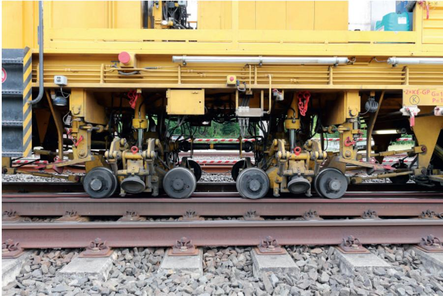
1: Ausschnitt des DGS 09-3X-Dynamic [5] mit einem Doppelaggregat
