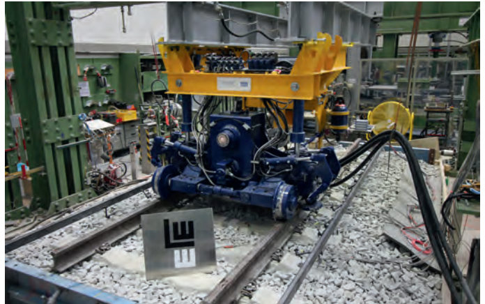
Abb. 7: Elektrisch und hydraulisch angeschlossener DGS auf Position 1 im Labor Quelle Abb. 1-7: TUM, Prüfamts Verkehrswegebau
