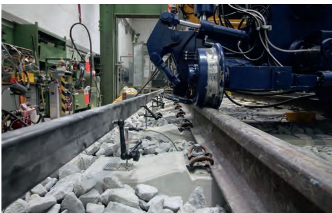
Abb. 4: Vertikal angeordnete Induktivwegaufnehmer an Messbasis befestigt
