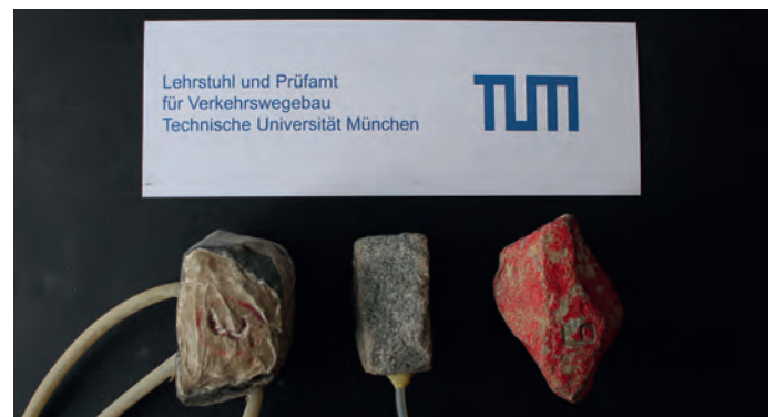
Abb. 5: Schottermesssteine (Sms), vom Lehrstuhl und Prüfam für Verkehrswegebau entwickelt (links: triaxialer Sms; Mitte: einaxialer Sms; rechts: triaxialer und kabelloser Schottermessstein)
