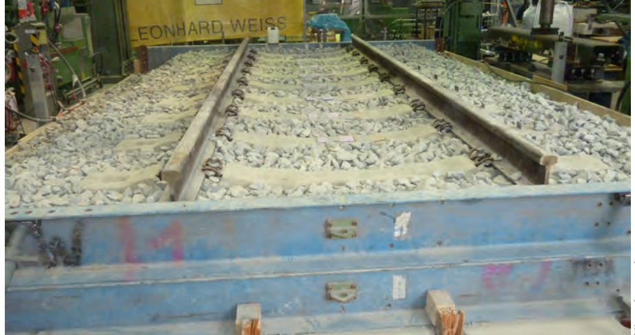
Abb. 3: Eingeschotterter Gleisrost mit neun Schwellen im Labor
