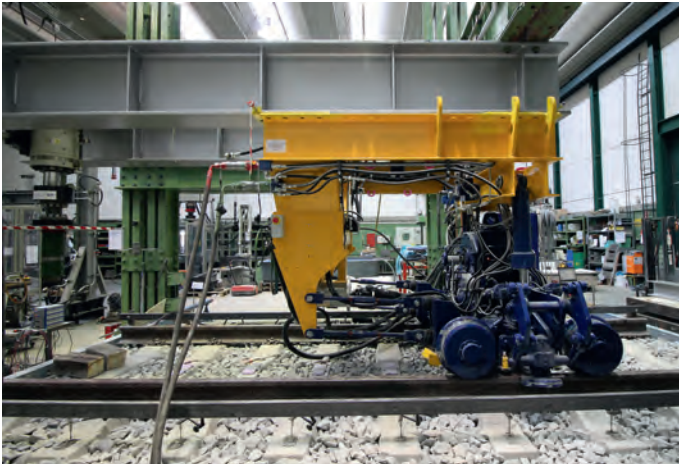
Abb. 6: Entkoppelter, elektrisch angetriebener DGS
