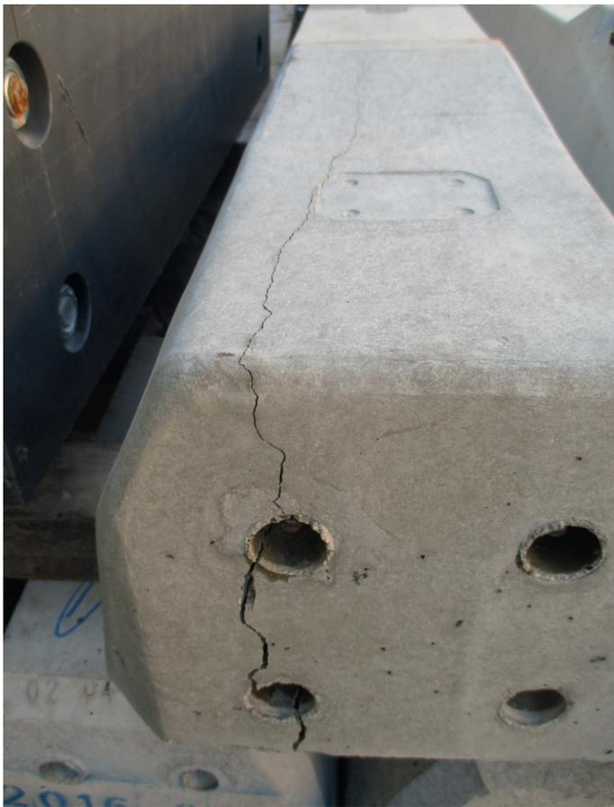
Abb. 1: Längsrissegeschädigte Spannbetonschwelle
