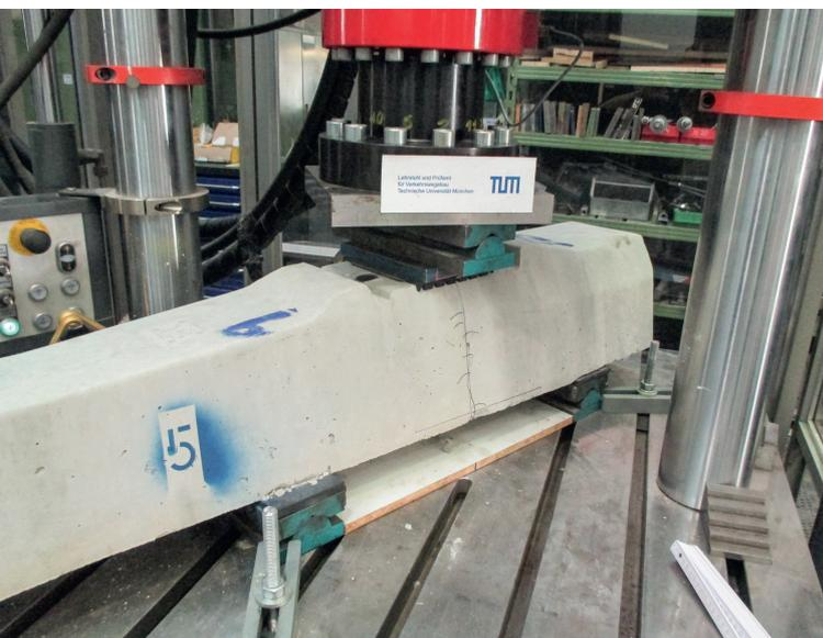
**Abb. 2:** Versuchsaufbau mit einer Schwelle nach Abschluss der Untersuchung
