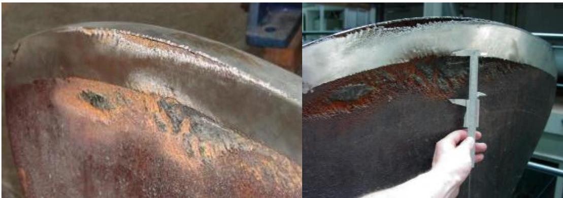
Erosion durch Flächenkavitation an der Laufschaufel einer kleinen Kaplan-Turbine
