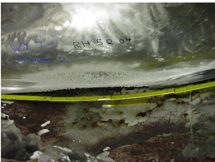
Erosion durch Flächen- und Außenspaltkavitation
