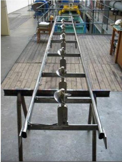
Messrahmen mit hydrometrischen Flügeln
