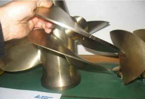
Fertigung und Einbau der Laufradschaufeln mit modifiziertem Profil
