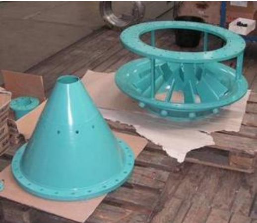
Komponenten der Modellturbine vor der Montage
