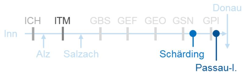
Abbildung 10: Skizze des unteren Inn mit Abfolge der Pegel und Staustufen (siehe auch Abbildung 5)
