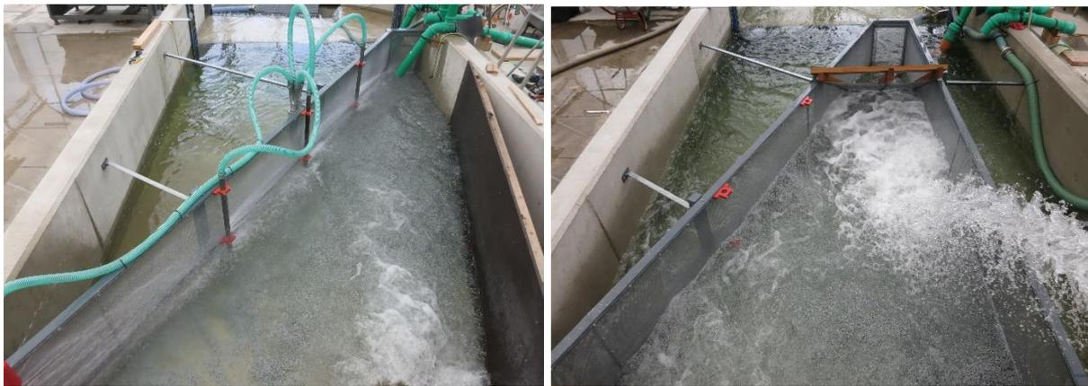
**Abbildung 18: Sedimentfang vor (links) und nach Umbau (rechts)**
