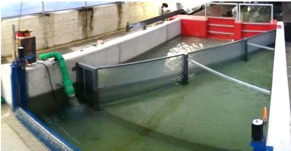
**Abbildung 17: Sedimentfang mit Unterwasserschütz von unterstrom, erste Konfiguration**
