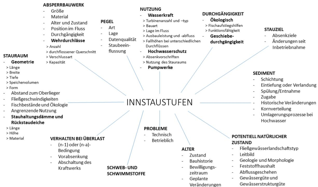
**Abbildung 1: Mögliche Parameter zur Charakterisierung von Staustufen**
