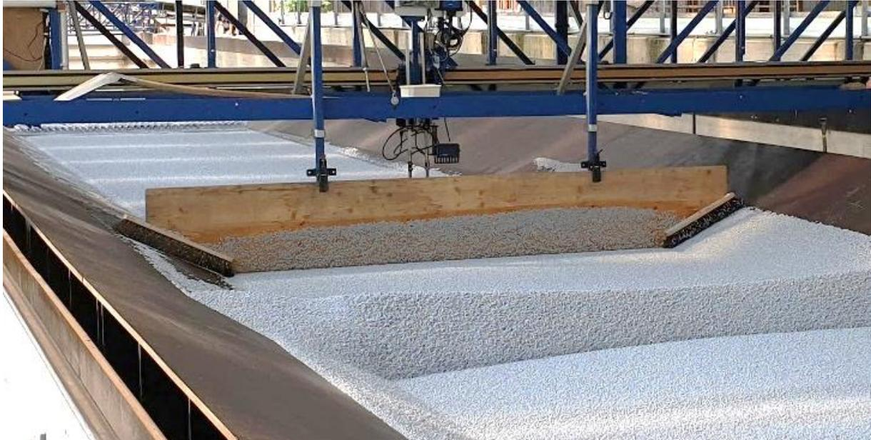
**Abbildung 44: Vorbereiten der Stauraumsohle für den Versuch**
