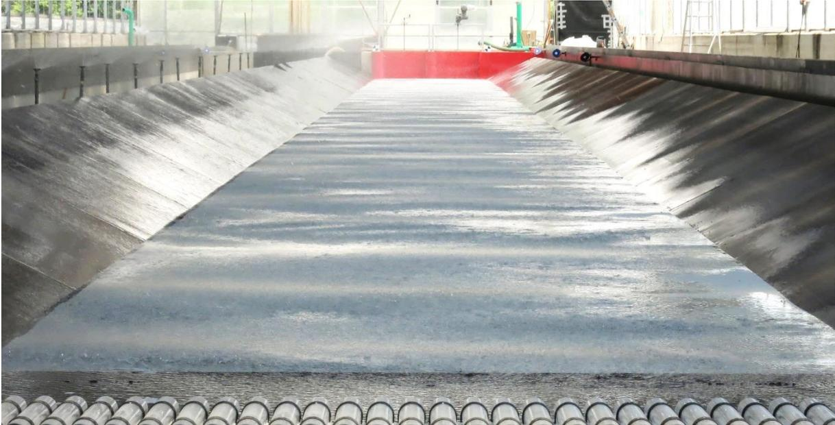
**Abbildung 45: Einstau des Versuchsstands mit Beregnung**
