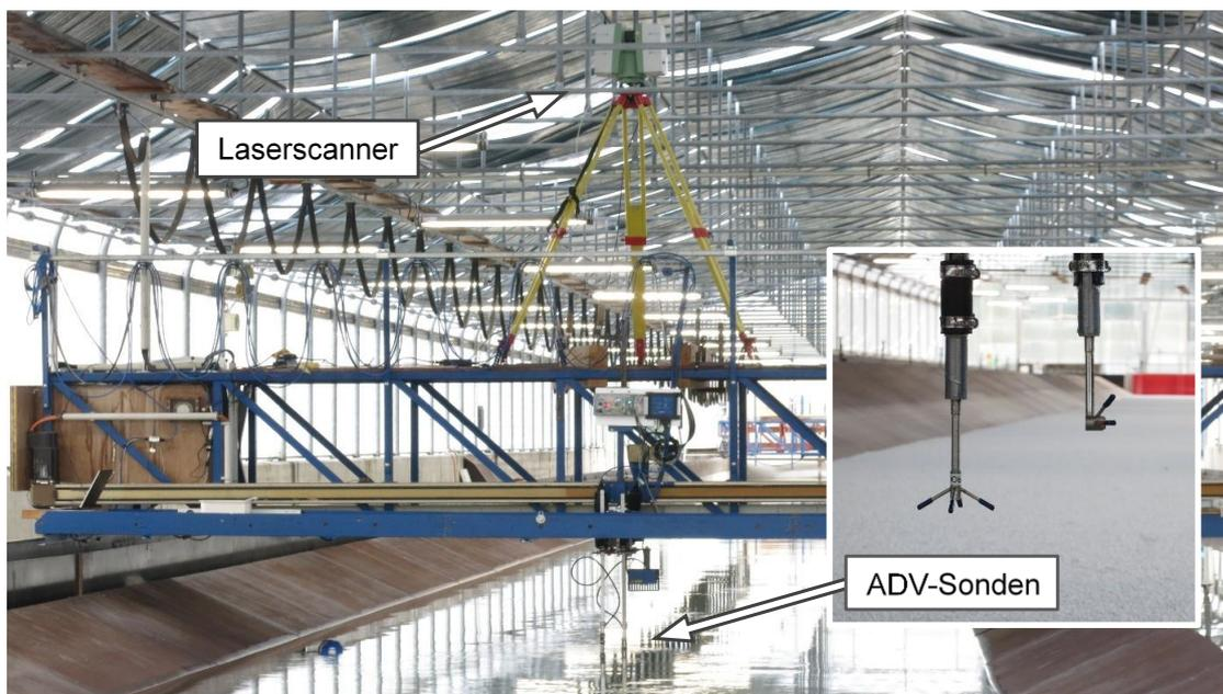
Abbildung 14: Messwagen mit Laserscanner und ADV-Sonde
