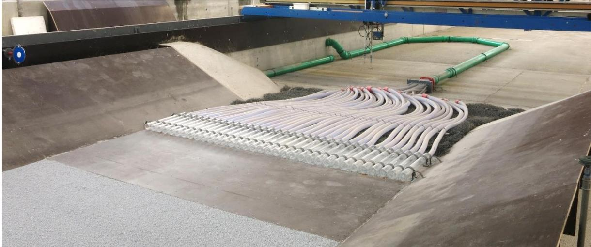
Abbildung 13: Einlaufbereich in die Stauraumstrecke mit Sedimentzugabevorrichtung (im Hintergrund: ADV-Sonden zur Geschwindigkeitsmessung am Messwagen)
