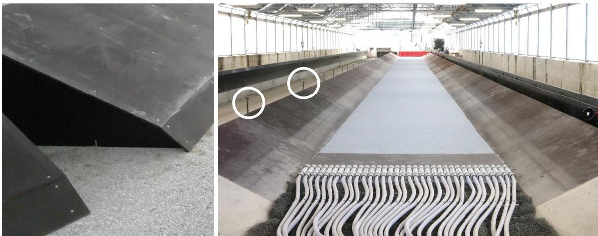
**Abbildung 15: Uferelemente in der Aufbauphase (links), Gerader Stauraum vor Versuchsbeginn (rechts)**
