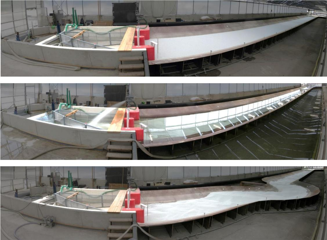
**Abbildung 21: Ansichten Versuchsstand: „Gerader Stauraum“ vor Versuchsbeginn (oben), „Gerader Stauraum“ während Betrieb (Mitte), „Gekrümmter Stauraum“ nach Versuchsende (unten)**
