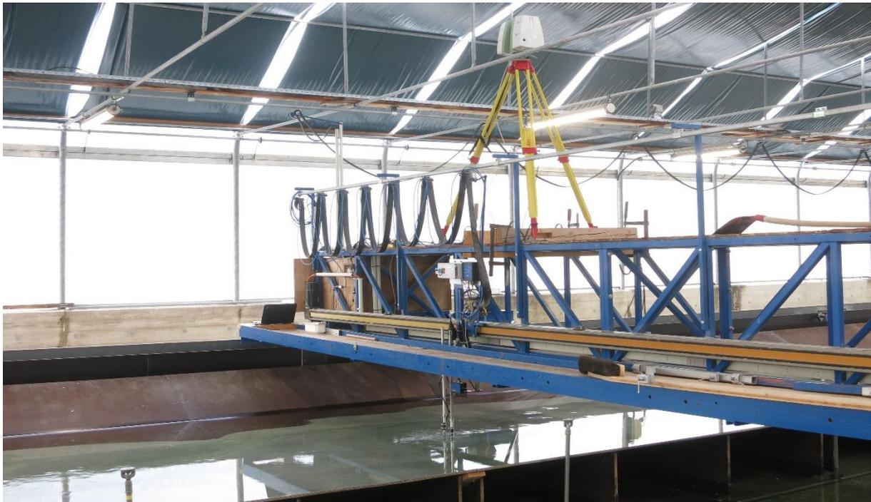
**Abbildung 50: Sohlvermessung mittels Laserscanning auf dem Messwagen und Geschwindigkeitsmessung mittels ADV unter dem Messwagen im Betrieb**
