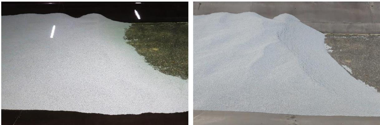
**Abbildung 52: Sohlstruktur nach Ende eines Versuchs: vor Entwässerung (links) und danach (rechts)**
