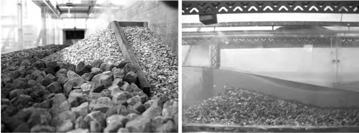
Abb. 8.6: Setzen des Deckwerks auf einer Filterschicht - Bauzustand (links) und Belastung des Versuchs mit  $Q_{max,Natur} = 911 \text{ m}^3/\text{s}$  (rechts)
