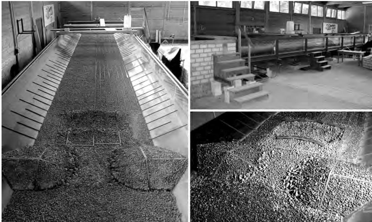
Abb. 5.21: Geplante V-Rampe an der Iller bei Fluss-km 13,8 in der neuen Versuchsrinne
