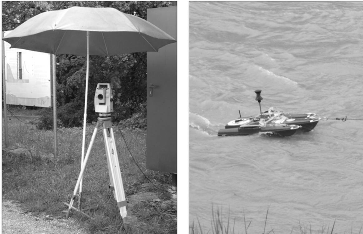
Abbildung 6.42: Totalstation von Leica am Ufer und ADCP-Boot mit 360°-Prisma
