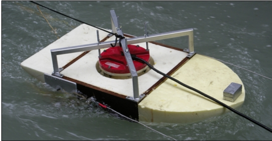
Abbildung 6.3: ADCP-Schwimmkörper aus Styrodur
