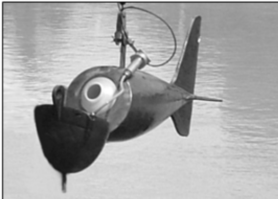
Abbildung 3.1: Schwebstoffprobenentnahme mit einem US-P61 Suspended Sediment Sampler (Messgerät des hydrographischen Dienstes Tirol)
