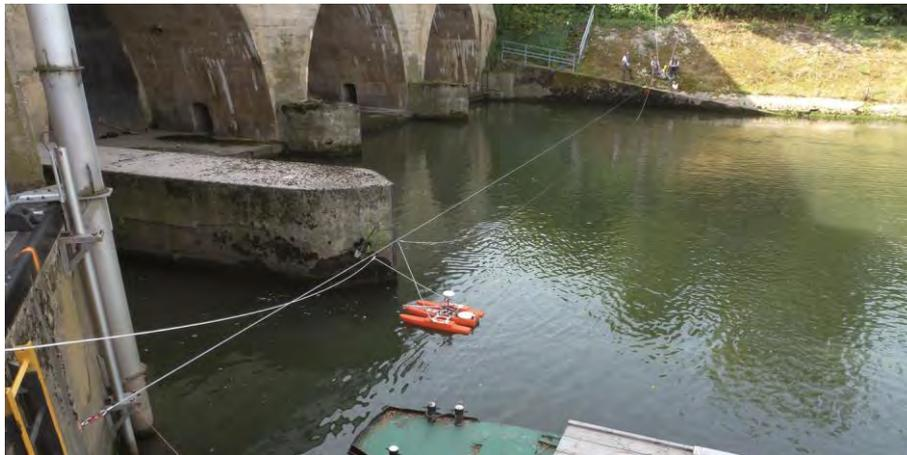
**Abb. 3** Messaufbau zur Erfassung der Strömungsgeschwindigkeiten im Kraftwerksunterwasser. Es ist keine Turbulenz sichtbar, da die Turbinen zum Zeitpunkt der Fotoaufnahme abgeschaltet waren.
