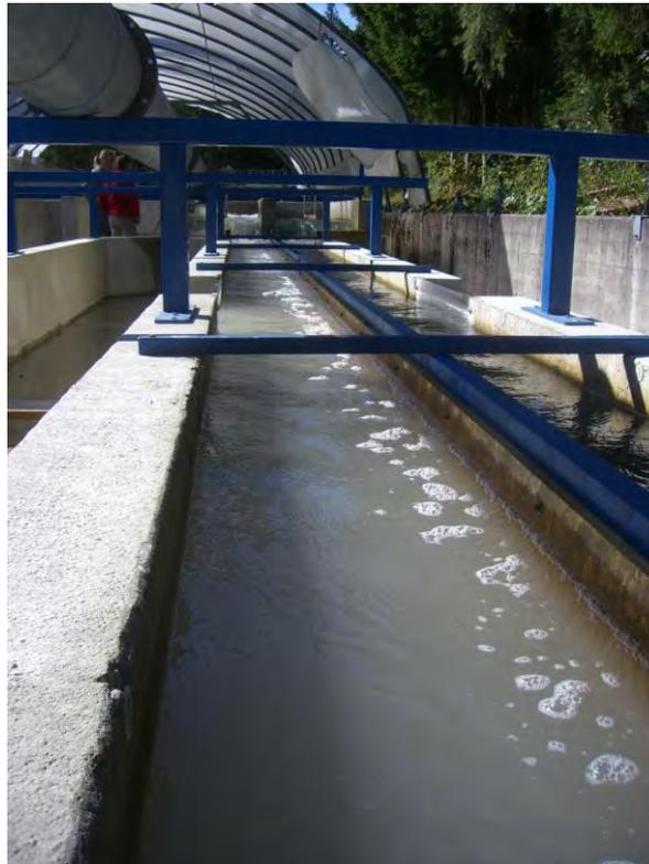
**Abb. 1** Zwei von vier parallelen Versuchsrinnen in der Versuchsanstalt Obernach mit Rohrleitung
