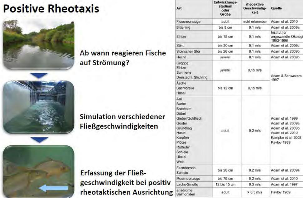
**Abb. 7** Ethohydraulische Tests und deren Befunde zur rheotaktischen Ausrichtung diverser Fischarten.
