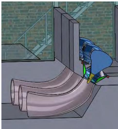
**Abb. 7** Anordnung von Turbinen und Saugrohren vor dem Schaufenster (Bader & Siewert, 2012)
