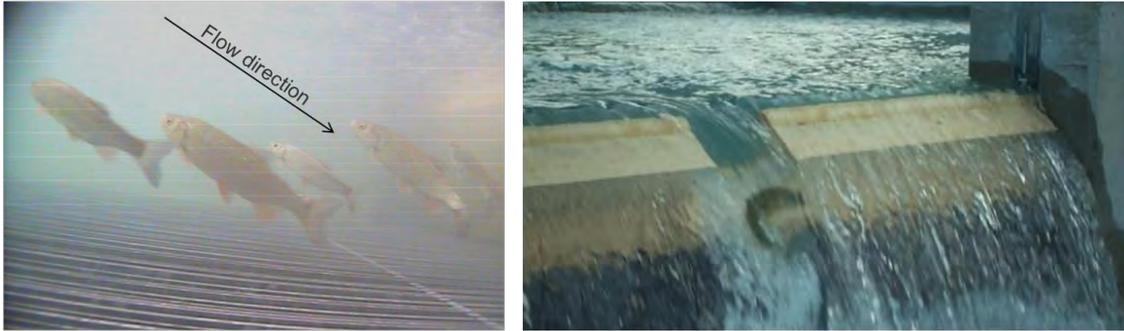
**Abb. 3** Aiteln mittlerer Größe über dem Rechen (links) und eine große Bachforelle beim Abstieg durch die oberflächennahe Öffnung (rechts)
