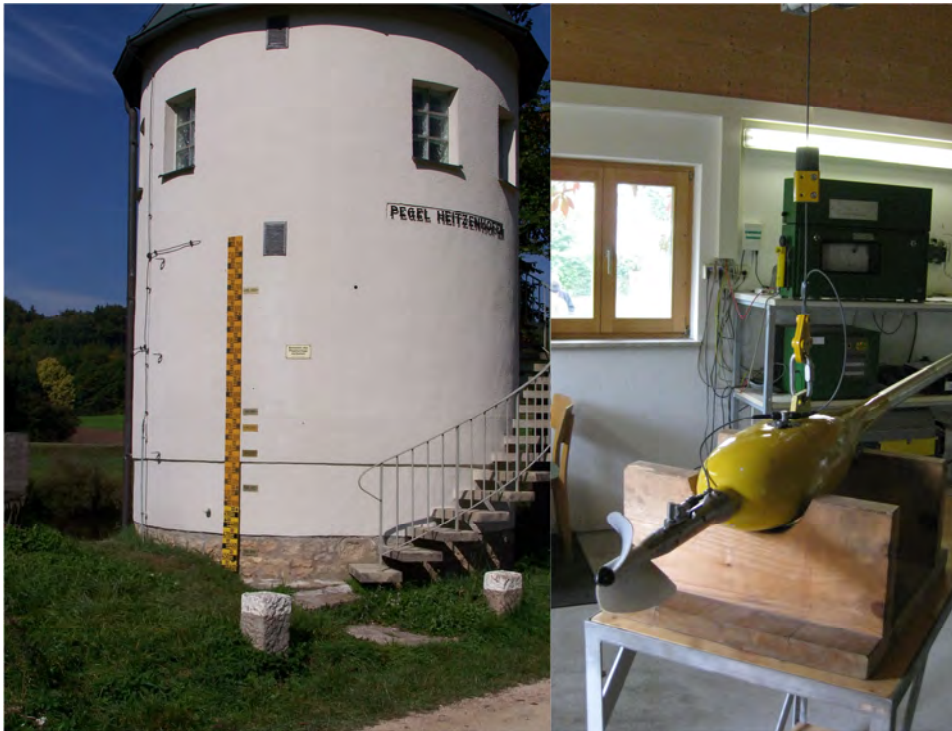
Abbildung II - 10: Wasserstands und Abflussmessung an Pegeln. Links: Pegel Heitzenhofen an der Naab mit Pegellatte. Rechts: hydrometrischer Flügel zur Messung von Fließgeschwindigkeiten.
