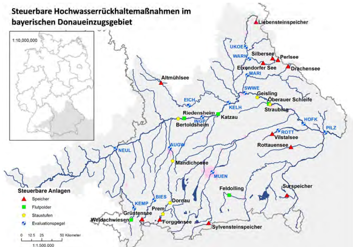
Abbildung II - 26: Lagekarte steuerbarer Hochwasserrückhaltmaßnahmen im Untersuchungsgebiet. Dargestellt sind größere Speicher (rote Dreiecke), Flutpolder (zum Teil geplant, grüne Vierecke) und größere Staustufen (gelbe Fünfecke).
