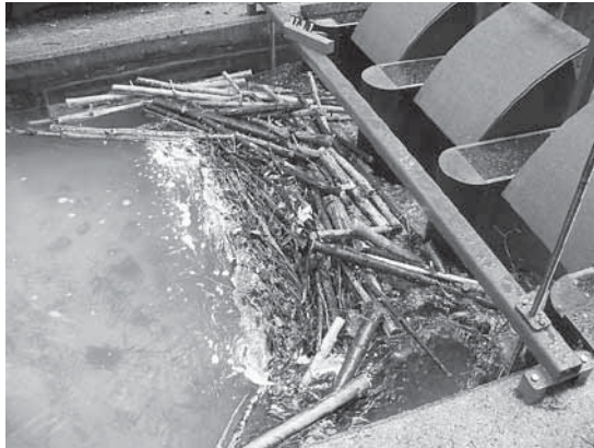
Abb. 3.28: Kompakte, mehrlagige Verkläusung des Dreifeldmodells mit zusätzlichem Feinmaterial
