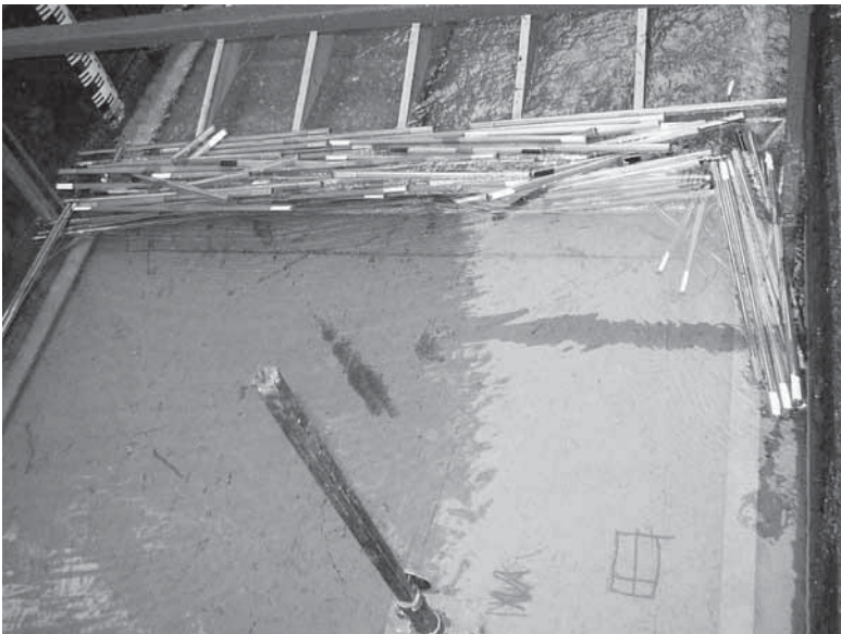
Abb. 3.37: Kompakter, mehrlagiger Verkläusungskörper aus Kunstholz vor flach geneigtem Rechen ( v = 0,348 m/s; Fr = 0,231 ; \rho_H = 975 kg/m 3 ; \alpha = 20^\circ )
