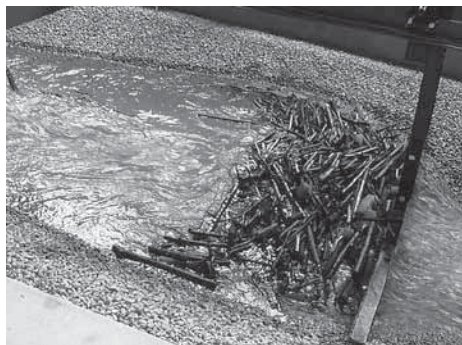
Abb. 2.34: Verklausung eines Schwemmholznetzes im Modellversuch (Foto: Rimböck)
