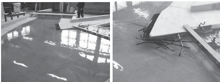
Abb. 4.40: Anprall eines einzelnen Schwemmholzstammes an die rechte Ufermauer am Kanalbeginn (links) und Ansammlung einer Holzgruppe am Trennungsbauwerk zwischen Wehr und Kanal (rechts) im Lastfall Q_{\text{Wehr}} = 550 \text{ m}^3/\text{s} und Q_{\text{Kanal}} = 150 \text{ m}^3/\text{s}
