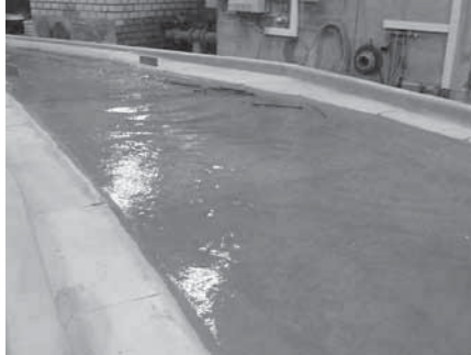
Abb. 4.38: Eintrag einer Schwemmholzgruppe am linken Aareufer für Q_{Aare} = 1650 \text{ m}^3/\text{s}
