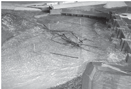
Abb. 4.30: Auflösung und Ausrichtung einer Schwemmholzansammlung an den Leitpfählen 2 und 4
