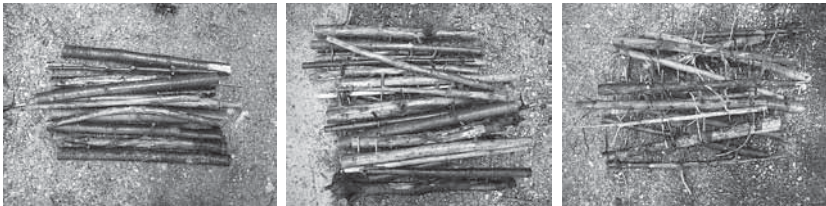
Abb. 3.11: Schwemmholz ohne Äste, mit wenigen und kürzeren Ästen sowie mit vielen und längeren Ästen (von links)
