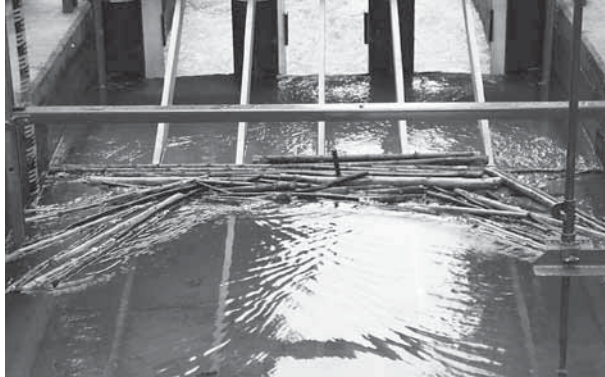
Abb. 3.40: Verklausung des flach geneigten Rechens mit Naturholz
