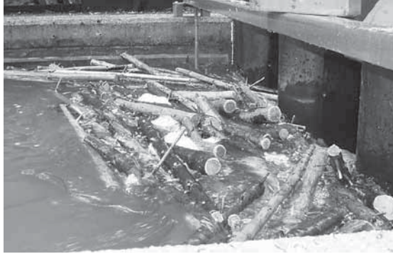
Abb. 3.17: Kompakter, mehrlagiger Verklauskörper im Dreifeldmodell
