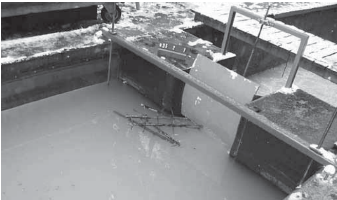
Abb. 3.12: Verklauung des teilgeöffneten Drucksegments im Einfeldmodell mit einer Holzgruppe
