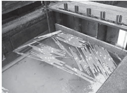
Abb. 3.21: Lockerer, einlagiger Schwemmholzteppich ( \rho_H = 800 \text{ kg/m}^3 , v = 0,168 \text{ m/s} , Fr = 0,077 )
