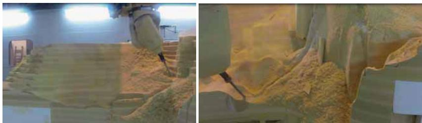
**Abb. 3** Fräsvorgang für die Geometrie des physikalischen Modells
