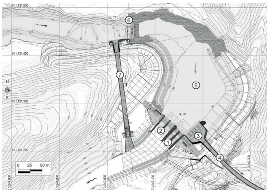
**Abb. 1** Plan der Sperre mit den tief liegenden Spülschützen (1), dem regulierten Überfallwehr (2), der Seitenentnahme (3), dem Triebwasserstollen (4), dem natürlichen Absetzbecken (5), dem Kofferdamm (6) und dem Sedimentumleitstollen (7).
