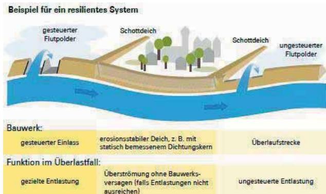
**Abb. 2** Darstellung eines resilienten Hochwasserschutzsystems
