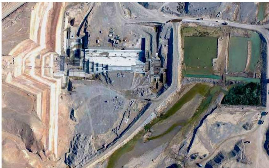
**Abb. 7** Luftbild der Baugrube (links) und der Kofferdämme nach einem Hochwasserereignis
