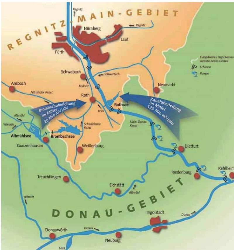
**Abb. 4** Das Wasserbauliche Großprojekt der Überleitung von Altmühl- und Donauwasser In das Regnitz-Maingebiet
