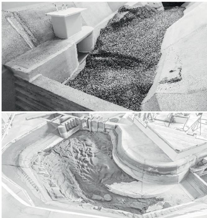
**Abb. 5** Verbleibende Verlandung nach der jährlichen Spülung mit  $Q = 150 - 200 \text{ m}^3/\text{s}$ . Oben: Spülung der Geschiebeablagerungen durch den Umleitstollen nach einem  $HQ_{350}$ . Unten: Spülung der Feinsedimente durch die Spüldurchlässe nach einem  $HQ_{20}$ , modelliert mit gemahlene Walnusschalen.
