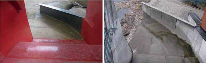
**Abb. 9** Optimierte Lösung mit der schrägen, überdachten Leitwand im Unterwasser des zusätzlichen vierten Wehrfelds in Modell und Original
