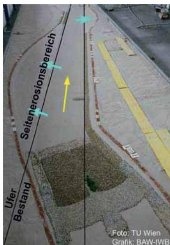
**Abb. 2** Modellversuch im Maßstab 1:50 vor Versuchsbeginn
