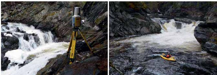
**Abb. 2** Messmethoden zur Erstellung des digitalen Geländemodells, links: terrestrischer 3D Laserscanner, rechts: GPS kombiniert mit Echolotmessung
