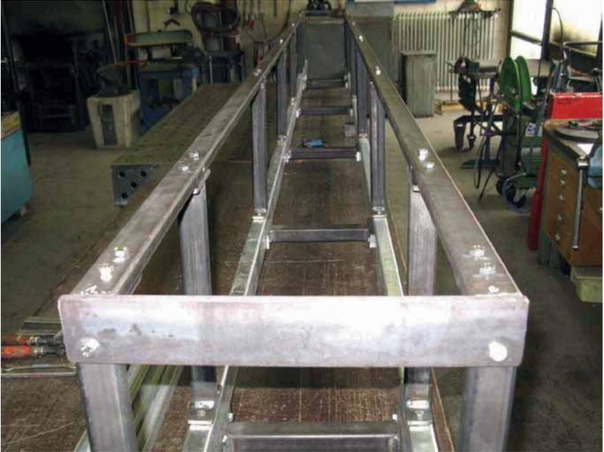
**Abb. 4** Versuchsrinne ( $B = 0,25$  m) im Bauzustand
