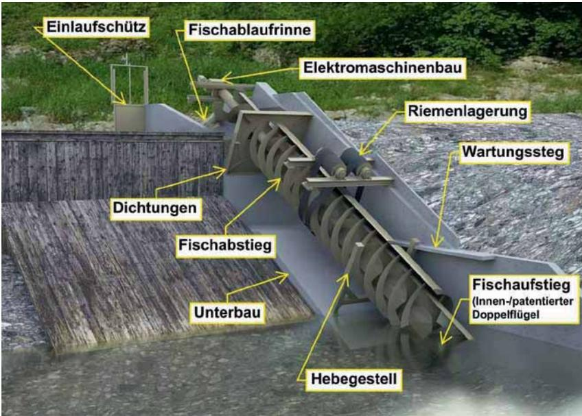
**Abb. 4** Wasserkraftschnecke der Firma Hydroconnect GmbH
