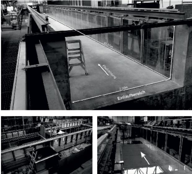
**Abb. 2** Laborrinne (oben) vom Einlauf aus gesehen; Rinnenabschnitt mit seitlichem Bypass zum Nebenkompartment (links unten); Modulare Einbauten (rechts unten) hier: horizontaler Schrägwehrechen mit anschließender runder Bypassöffnung
