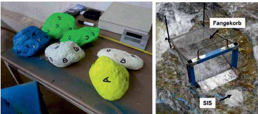
**Abb. 3** Farbracersteine (links) (Spreitzer, 2014) und Sediment Impact Sensor (SIS) auf einer Rampe im Schöttlbach mit Geschiebefangkorb
