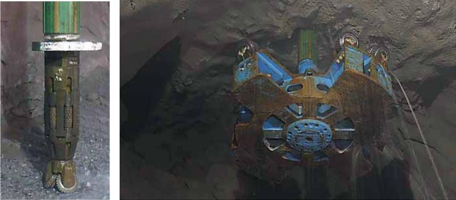
**Abb. 6** Raise-Boring Verfahren, Bohrkopf Pilotbohrung (links), Aufweitungskopf an Bohrgestänge (rechts)
