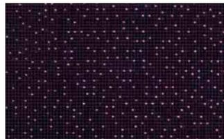
**Abb. 1** links: Der Kinect-Sensor mit seinen Bestandteilen (Microsoft); rechts: Beispiel eines projizierten Infrarotmusters (Reichinger 2011)
