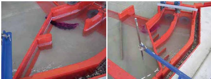
**Abb. 3** Kraftwerksanströmung im maßgebenden Lastfall für den Ausgangszustand (links) und den optimierten Zustand (rechts)
