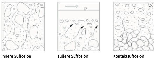
Abbildung 5: Erscheinungsformen der Suffosion nach Ziems (1968) (BAW 2011)
