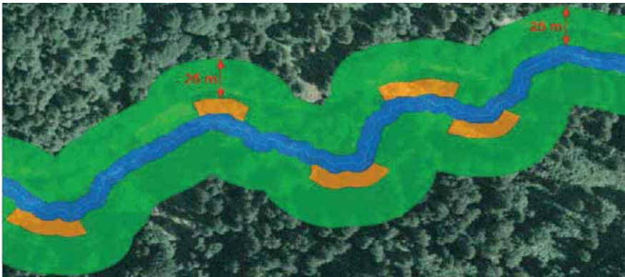
Abb. 6 Ausweisung der relevanten Prozessflächen: Windwurfflächen (grün), Uferbestockung (blau), Ufererosion (orange). In diesem Beispiel erreicht keine Rutschungsfläche den Flussschlauch.
