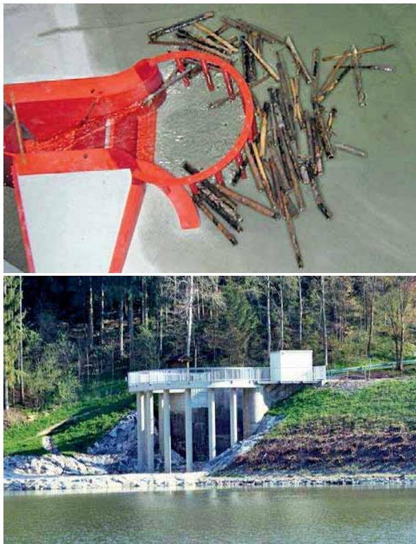
Abb. 3 Einlaufbauwerk der Hochwasserentlastungsanlage am Grüntensee mit Schutzeinrichtung zum Schwemmholzrückhalt in Modell und Original
