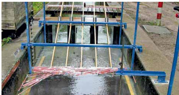
Abb. 4 Schutzeinrichtung vor einem Wehrbauwerk mit stark geneigten Rechenstäben, weit vorgelagerter Basis und großem Stababstand (großmaßstäblicher Modellversuch)
