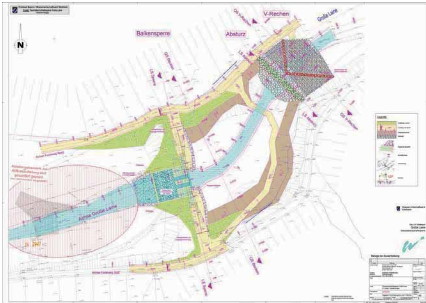
Abb. 9: Lageplan Wildholzrechen und Geschieberückhaltesperre
