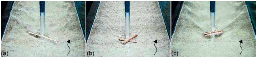
Abb. 4 Modellversuche zur Ermittlung der Verklauungswahrscheinlichkeit bei einem kreisförmigen Brückenpfeiler mit (a) Einzeltransport, (b) schubweisem Schwemmholztransport und (c) schubweisem Schwemmholztransport mit Hölzern mit Ästen
