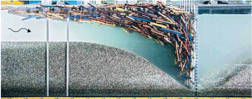
Abb. 10 Natürliche Schwemmholtverkläuerung mit beweglicher Sohle, massgebender Korndurchmesser des Sohlenmaterials d_m = 2.65 mm, Q_o = 40 l/s, F_o = 0.5 im Massstab 1:30
