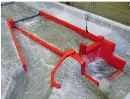
Abb. 3 u. 4: Modellversuch bei Versuchsanstalt der TUM in Obernach
