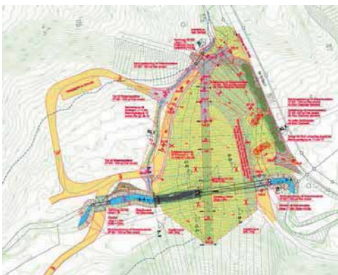
Abb. 3 Lageplan Hochwasserrückhaltebecken am Reitbach / Prien a. Chiemsee
