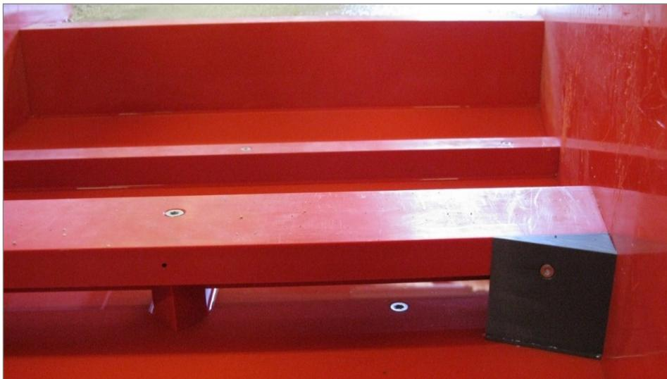
**Abb. 5** Optimierter Leitkeil (grau) im Tosbecken von HWE und GA (Blick in Richtung Unterwasser)
