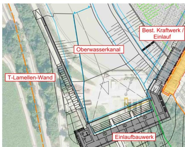
**Abb. 8** Lageplan Einlaufbereich KW Töging mit T-Lamellen-Schlitzwand
