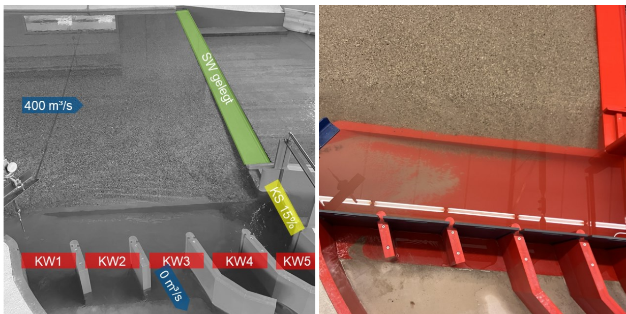
Abb. 7 links: Darstellung der Betriebssituation mit Anlagensteuerung im IST-Zustand; rechts: vernachlässigbarer Geschiebeeintrag in die Kiesfalle
