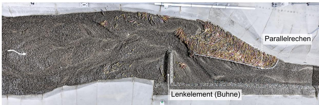
**Abb. 5** Holzablagerungen und morphologische Strukturen im Modell nach einem Ganglinienversuch  $HQ_{100}$  (v059). Im Parallelrechen wurden 65% ( $2'600 \text{ fm}^3$ ) des zugegebenen Schwemmholzes zurückgehalten.
