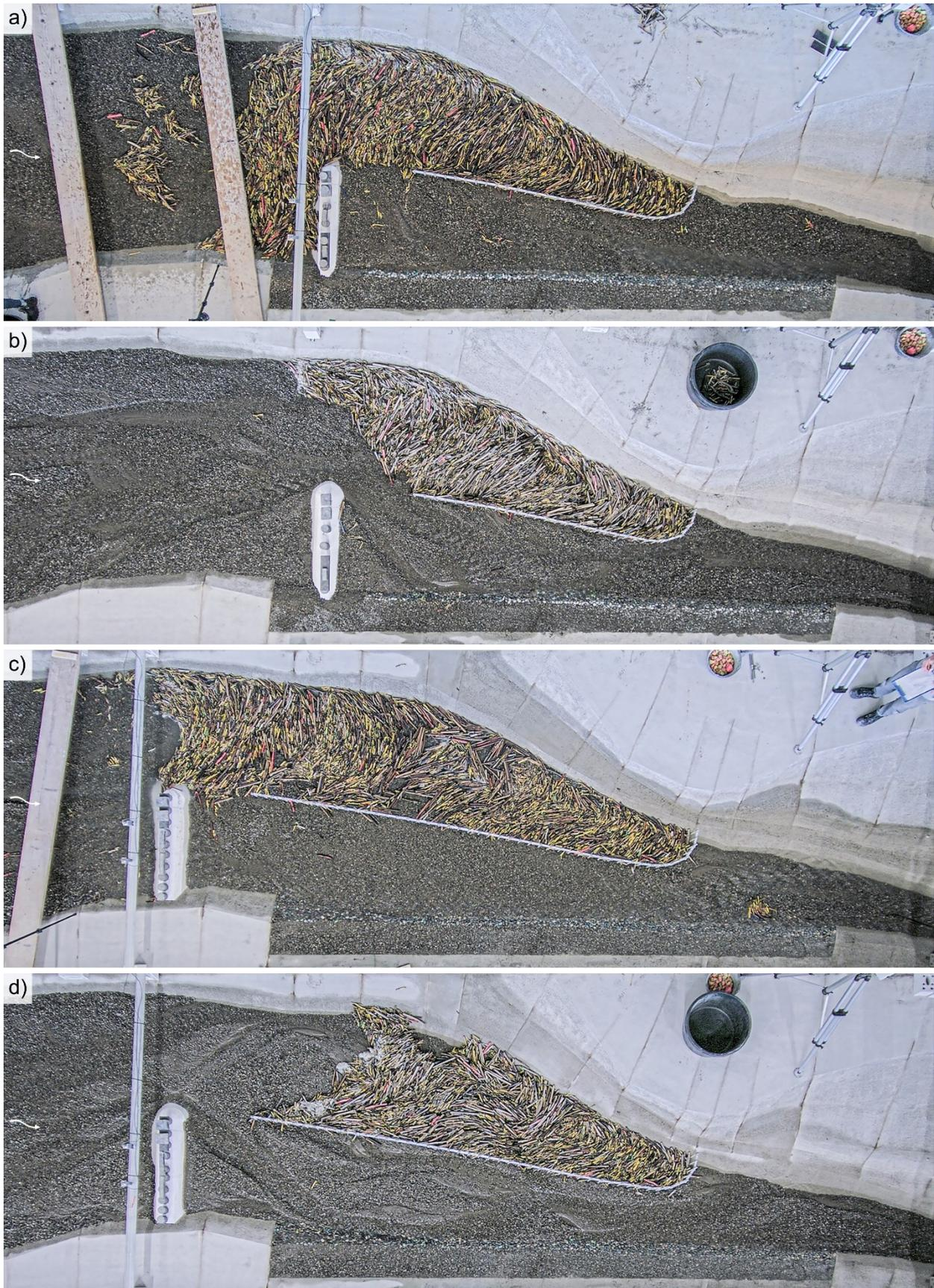
**Abb. 6** Holzurückhalt während der Ganglinienversuche  $HQ_{100}$  bei gesättigter Schwemmholzganglinie („ $Q_H$  gesättigt“ in Abb. 4 links). a) Basiskonfiguration ( $L_R = 115$  m) am Ende der Schwemmholzzugabe, b) Basiskonfiguration bei Versuchsende, c) verlängerter Rechen ( $L_R = 175$  m) am Ende der Schwemmholzzugabe und d) verlängerter Rechen bei Versuchsende.
