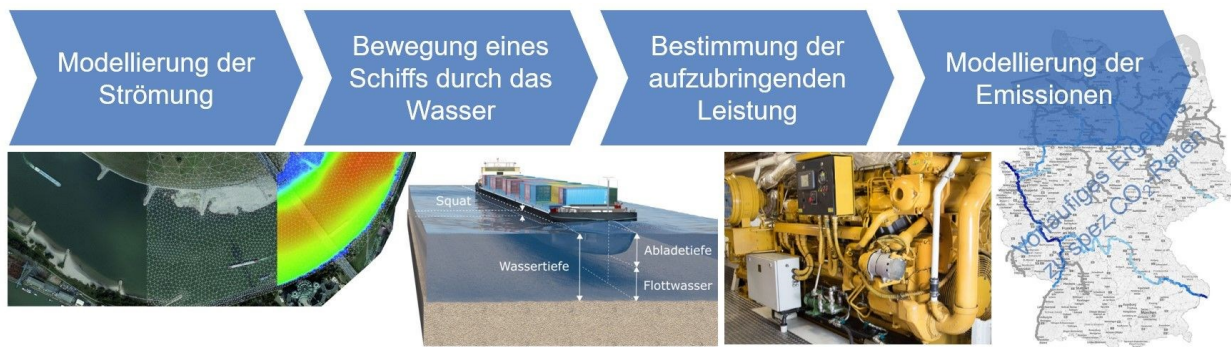
Abb. 2 Grundlegende Struktur zur Modellierung von THG-Emissionsraten auf Binnenschiffahrtsstraßen, aus Heinzelmann und Noss (2022)
