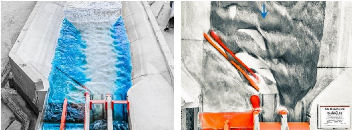
**Abb. 6** Links: Hydraulische Strömungsverhältnisse mit der visualisierten Hauptströmung im Stauraum bei HQ1(n-0), beide Turbinenfelder offen; Rechts: Funktionsweise der Geschiebeleitschwellen zur Sedimentverfrachtung und Sedimentabwehr. Lastfall HQ100(n-0), (Fotos: Piki/TU Graz)
