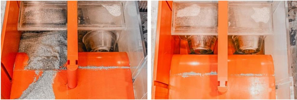
**Abb. 5** Links: Sedimenteintrag in die Turbineneinläufe Ausgangszustand (links) und Ausführungsvorschlag (rechts) nach einem HQ100 (Fotos: Piki/TU Graz)
