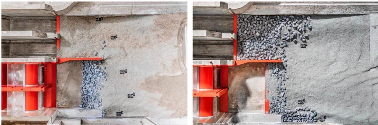
**Abb. 3** Draufsicht vom Erosionsverhalten des unterwasserseitigen Bereichs der Kraftwerksanlage, Kolkbildung bei Tosbeckenvariante 1 (links) und Nachkolkssicherung Variante 5, Lastfall (rechts) nach  $HQ_{100}(n-0)$ , (Foto: Piki/TU Graz)
