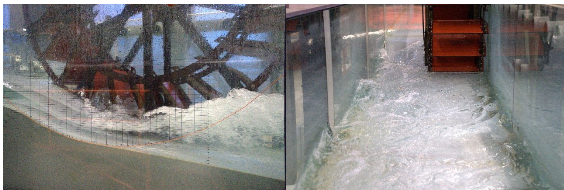
Abb. 3 Halbrad / h_{25}/Q_{143} / Seitenansicht (links) und Blick aus dem Unterwasser (rechts)
