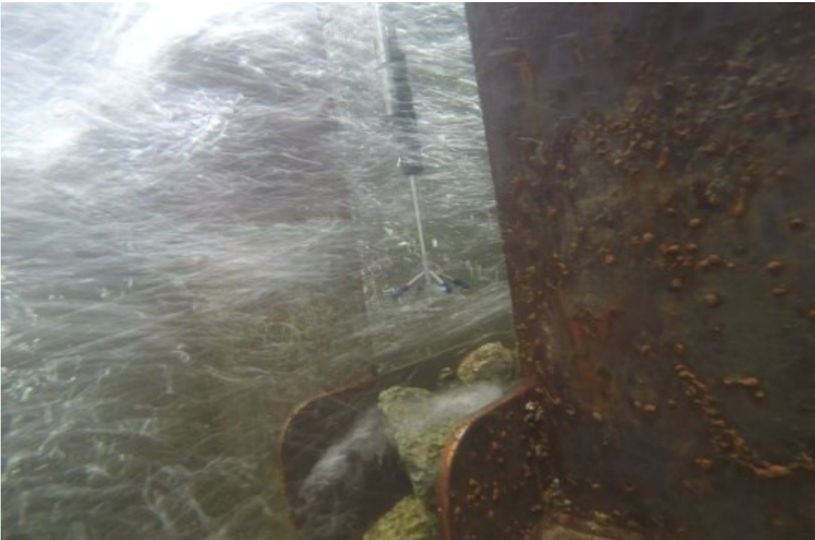
Abb. 3 Messung mit Vectrino-Sonde in einer zentrierten Messlotrechten
