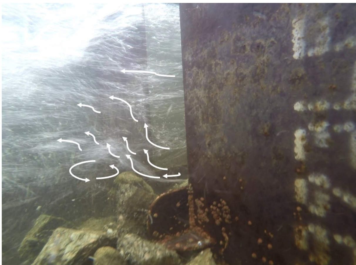
Abb. 7 Turbulenzen durch Störsteinanordnung
