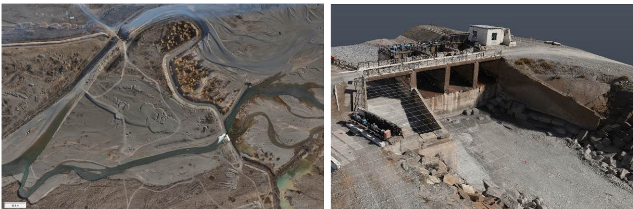
Abb. 3 Erstelltes Orthofoto (links) und Punktwolke (rechts)
