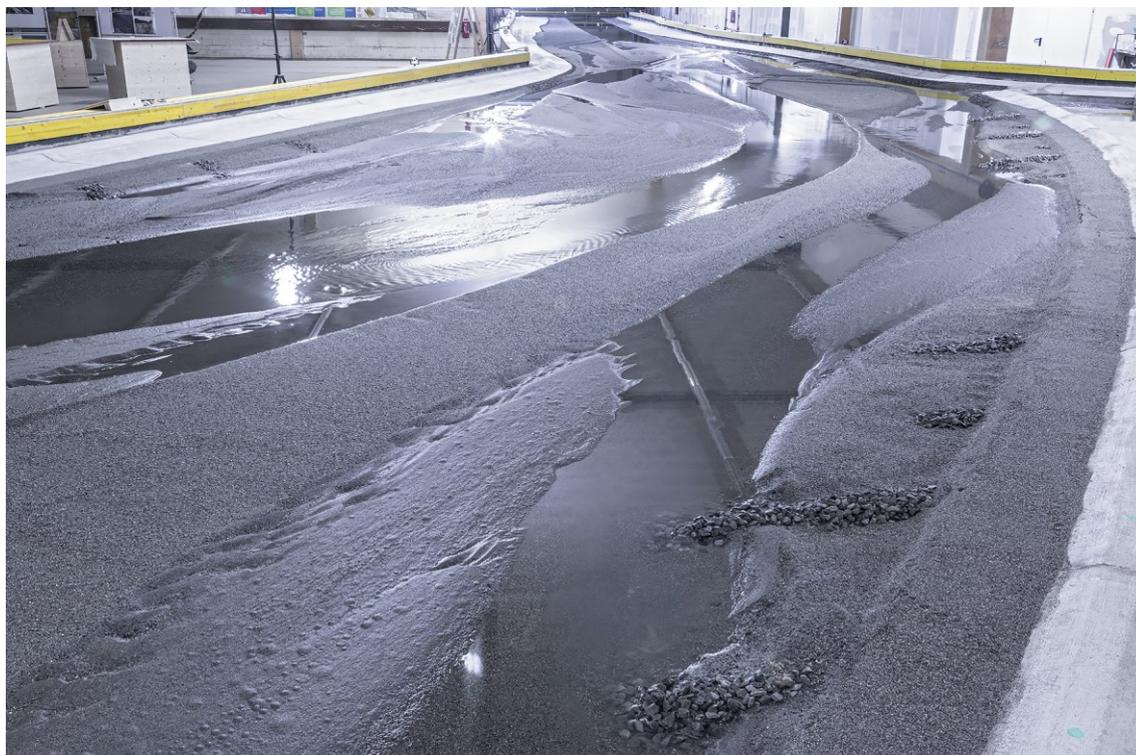
**Abb. 6** Abflussverhältnisse bei  $120 \text{ m}^3/\text{s}$  im ggst. Modell nach 20 durchschnittlichen Abflussjahren: rechts im Bild befindet sich der Initialisierungsgraben; links im Bild ist das zu diesem Zeitpunkt noch abgetrennte Hauptgerinne zu erkennen, Blick in Fließrichtung
