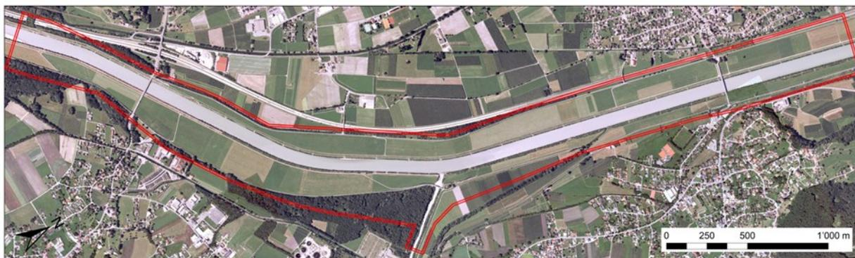
**Abb. 2** Orthofoto des Projektabschnitts Oberriet/Koblach (Rhein-km 66 bis Rhein-km 71) im Bestand mit den Modellmauern in rot, Fließrichtung von links nach rechts; in der Bildmitte Einmündung der Frutz (Quelle: Schweizer Bundesamt für Landestopografie)
