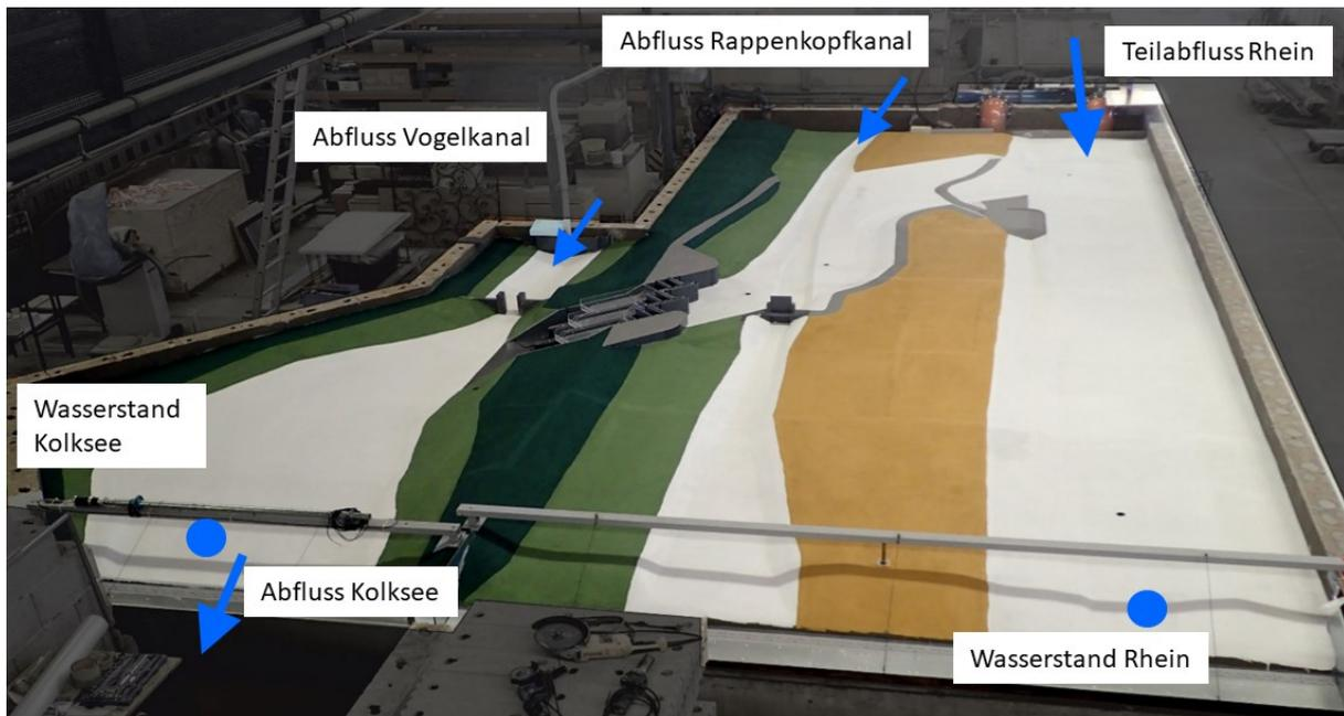
**Abb. 2** Abfluss- und Wasserstandsrandbedingungen für den Modellbetrieb
