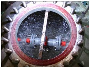
Nachdem keine genauen Angaben über den Zerstäubungsprozess des Düsenstrahls auf einer Peltonschaufel existieren, wurden zwei verschiedene Zerstäubungsersatzmodelle untersucht. Die Geometrie „Düse + Platte“ konnte als repräsentativ für die Zerstäubung am Prototyp angesehen werden.
