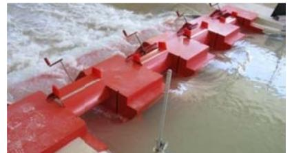
In einer abschließenden Modelluntersuchung wurde nach Entfernung der UW-Sohle zusätzlich eine Leistungskurve für den vollkommenen Überfall ermittelt.
