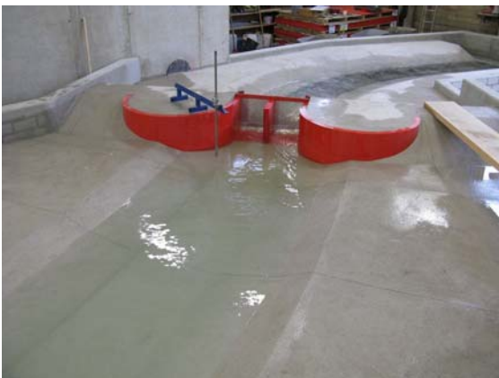
Ausleitungsbauwerk im Modellversuch
