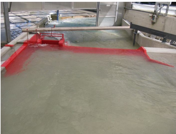
HQ 100,S am Wehr
