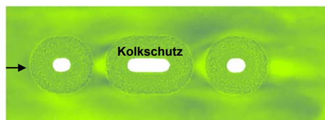
Höhendifferenz der Sohlgeometrie zwischen End- und Ausgangszustand in der Endsituation des Pfeilers ohne und mit optimiertem Kolkschutz (rot: max. Eintiefung, blau: max. Auflandung)
