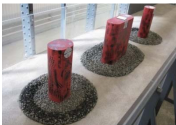
Endsituation des Pfeilers ohne und mit optimiertem Kolkschutz
